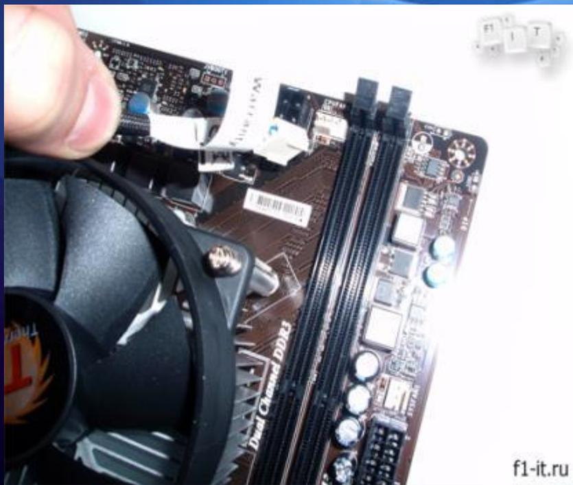
Нужно равномерно затянуть все винты крепления кулера, не допуская перекосов.
