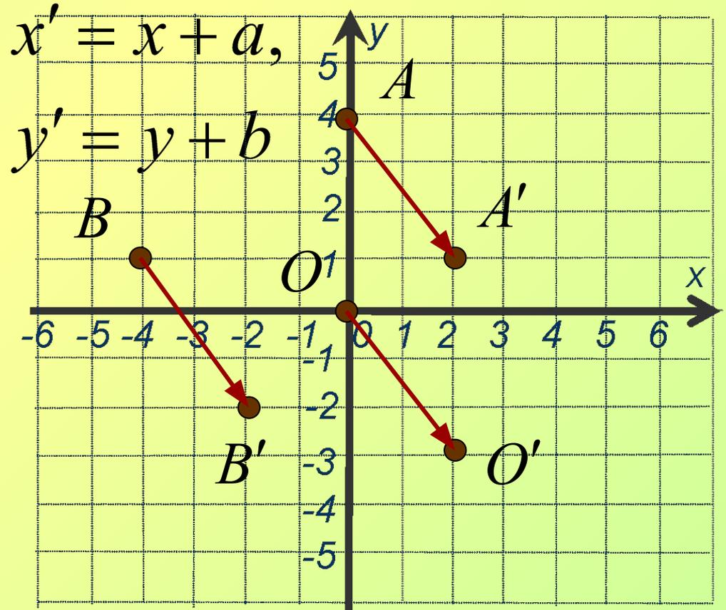
Параллельный перенос определяется как преобразование, при котором точки смещаются в одном и том же направлении на одно и то же расстояние.
