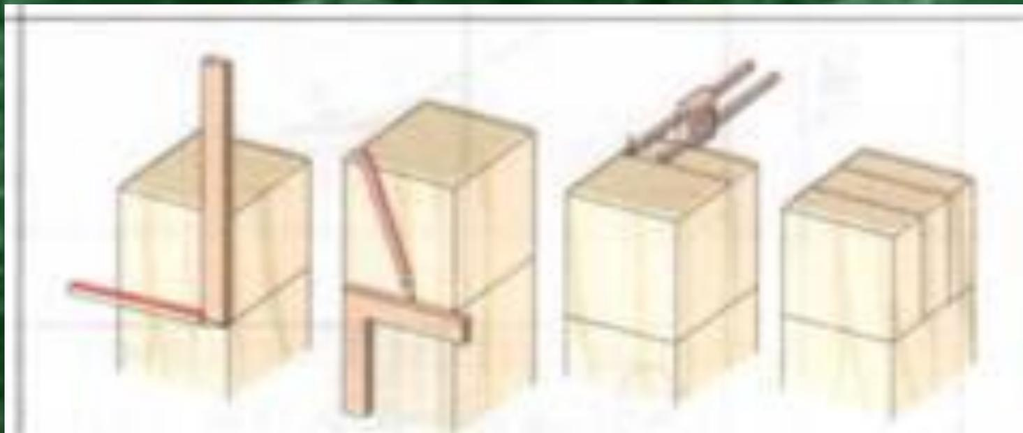
Проведите запиливание шипов и проушин пилой с мелкими зубьями по удаляемой части заготовки так, чтобы линии разметки остались.
