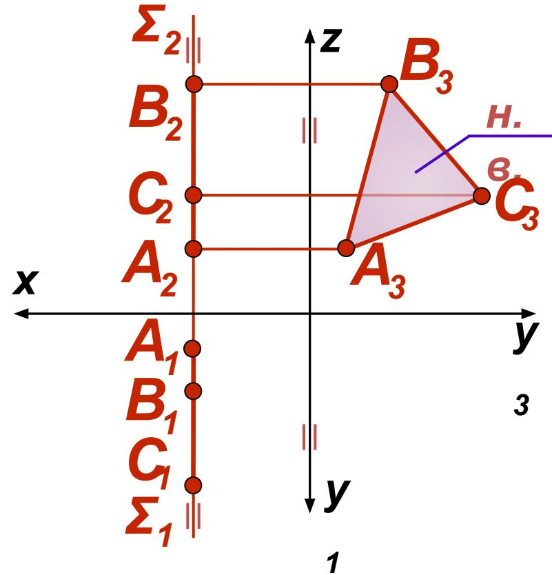
В силу параллельности следы (горизонтальный  $\Sigma_1$ , и фронтальный  $\Sigma_2$ ) плоскости  $\Sigma$  будут параллельны соответствующим осям координат. Фигура, задающая плоскость  $\Sigma$ , проецируется в натуральную величину на профильную плоскость проекций
