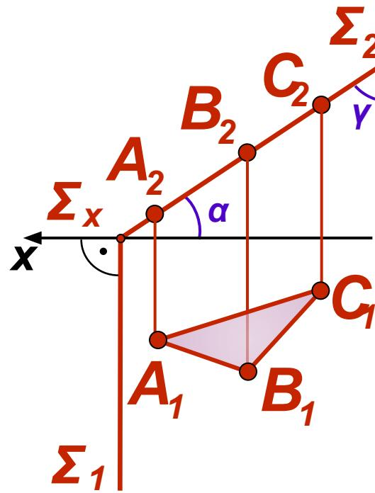
Фронтальная проекция плоскости  $\Sigma$  вырождается в прямую (след). На  $\Pi_2$  проекции трех произвольных точек плоскости лежат на фронтальном следе плоскости  $\Sigma_2$ . Углы наклона данной плоскости  $\Sigma$  к горизонтальной ( $\alpha$ ) и профильной ( $\gamma$ ) плоскостям проекций на  $\Pi_2$  не искажаются
