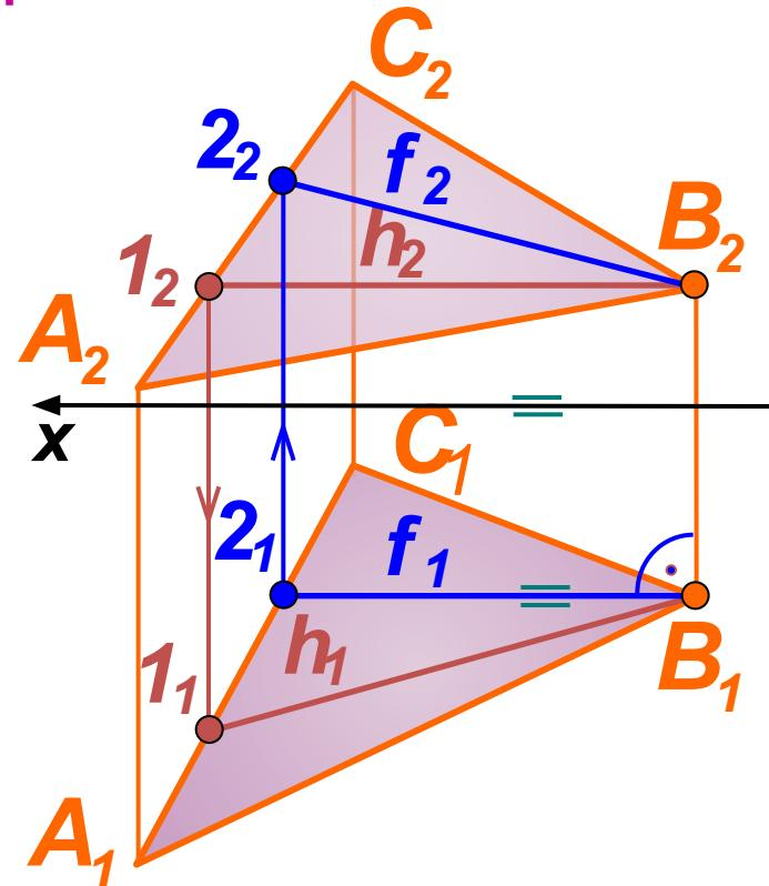
Фронталь плоскости – это прямая, лежащая в плоскости и параллельная фронтальной плоскости проекций.
