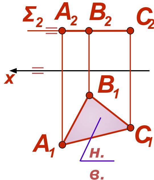
В силу параллельности следы (фронтальный  $\Sigma_2$  и профильный  $\Sigma_3$ ) плоскости  $\Sigma$  будут параллельны соответствующим осям координат. Фигура, задающая плоскость  $\Sigma$ , проецируется в натуральную величину на горизонтальную плоскость проекций
