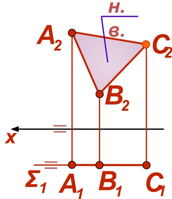
В силу параллельности следы (горизонтальный  $\Sigma_1$ , и профильный  $\Sigma_3$ ) плоскости  $\Sigma$  будут параллельны соответствующим осям координат. Фигура, задающая плоскость  $\Sigma$ , изображается в натуральную величину на фронтальной плоскости проекций
