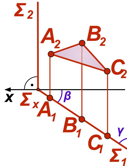
Горизонтальная проекция плоскости  $\Sigma$  вырождается в прямую (след), на  $\Pi_1$  проекции трех произвольных точек плоскости лежат на горизонтальном следе плоскости  $\Sigma_1$ . Углы наклона данной плоскости  $\Sigma$  к фронтальной ( $\beta$ ) и профильной ( $\gamma$ ) плоскостям проекций на  $\Pi_1$  не искажаются
