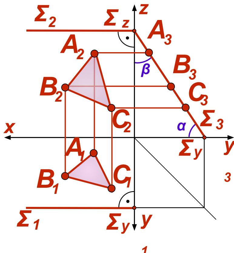
Профильная проекция плоскости  $\Sigma$  вырождается в прямую (след). На  $\Pi_3$  проекции трех произвольных точек плоскости лежат на профильном следе плоскости  $\Sigma_3$ . Углы наклона данной плоскости  $\Sigma$  к горизонтальной ( $\alpha$ ) и фронтальной ( $\beta$ ) плоскостям проекций на  $\Pi_3$  не искажаются
