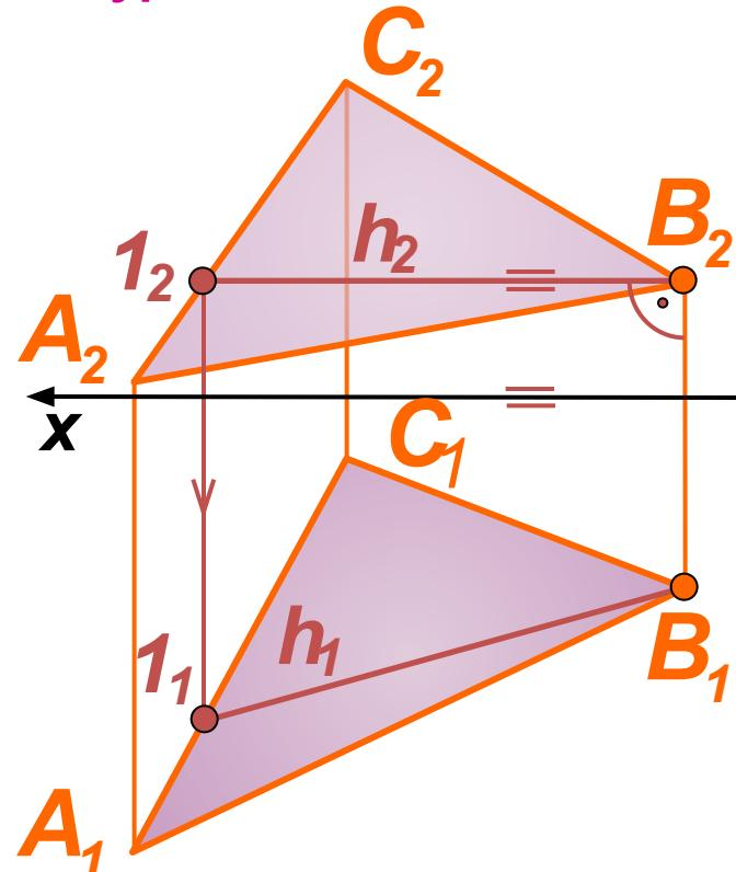
Горизонталь плоскости – это прямая, лежащая в плоскости и параллельная горизонтальной плоскости проекций. Фронтальная проекция горизонтали параллельна оси x. Положение горизонтали в плоскости определяют две точки (например,  $B$  и  $1$ )
