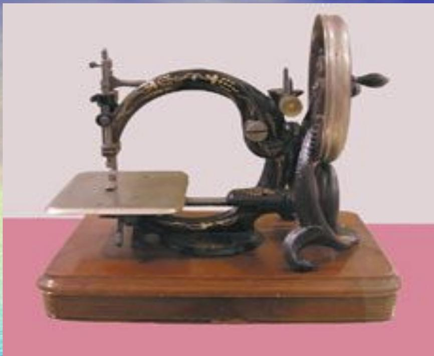
*Швейная машина цепного стежка фирмы „Вилькокx и Гиббс“ (США, Нью-Йорк, 1868). В данной машине кроме конструктивных узлов запатентован дизайн.*
