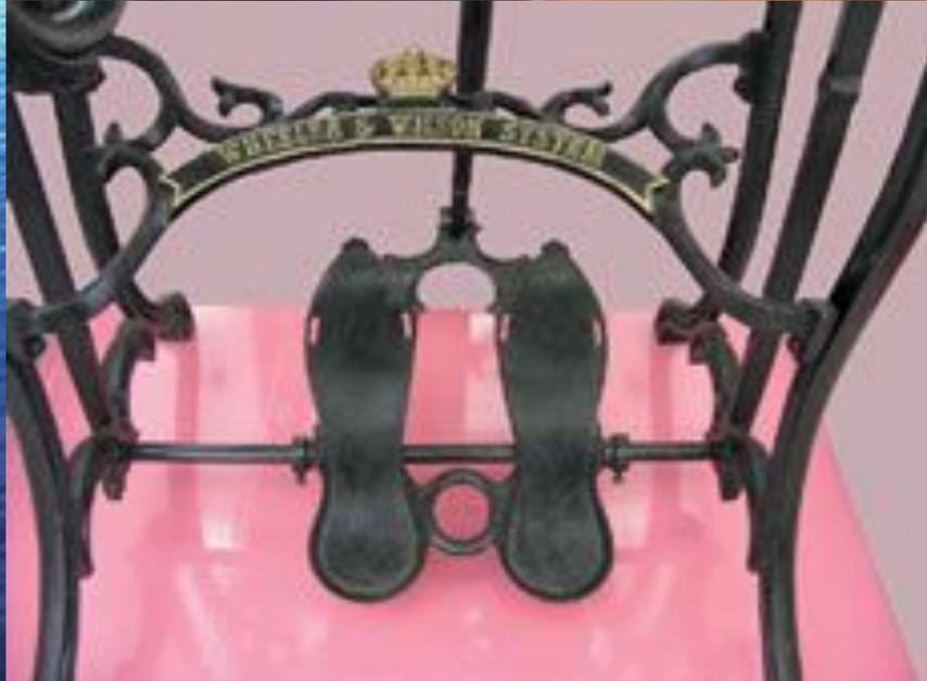
*Вверху — швейная машина двойной строчки с дуговой иглой фирмы „Виллер и Вильсон“ (США, 1854-1865) — один из первых образцов машин челночного стежка. Предназначена для белошвейных работ. Внизу — её ножной привод.*
