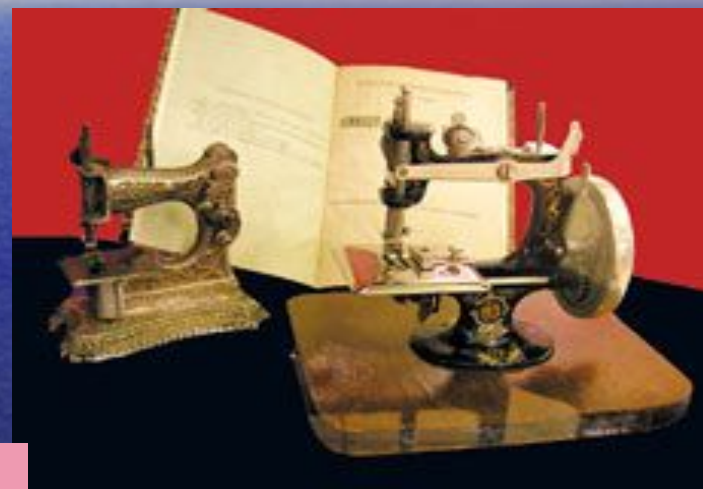
Швейные машины челночного стежка для стачивания тканей (подольский завод компании „Зингер“, 1905-1920).
