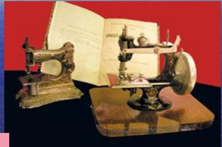
*Швейные машины челночного стежка для стачивания тканей (подольский завод компании „Зингер“, 1905-1920).*
