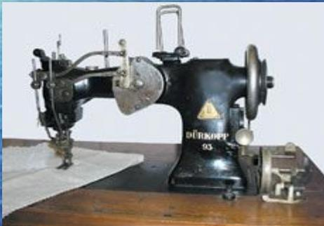
*Фабрично-ремесленная швейная машина челночного стежка фирмы „Дюркопп“ (Германия, 1900-1915). Предназначена для выполнения ажурных работ, всевозможных мережек для украшения одежды, столового и постельного белья.*
