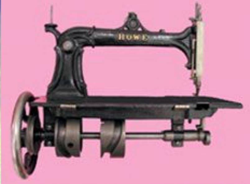
Фабрично-ремесленная швейная машина „Гоу“ челночного стежка для стачивания тяжелых тканей.
