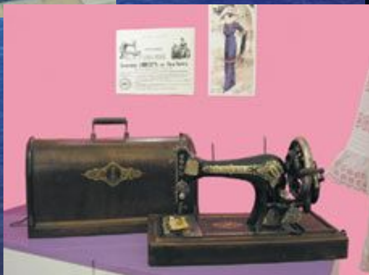
Швейные машины челночного стежка для стачивания тканей (подольский завод компании „Зингер“, 1905-1920).
