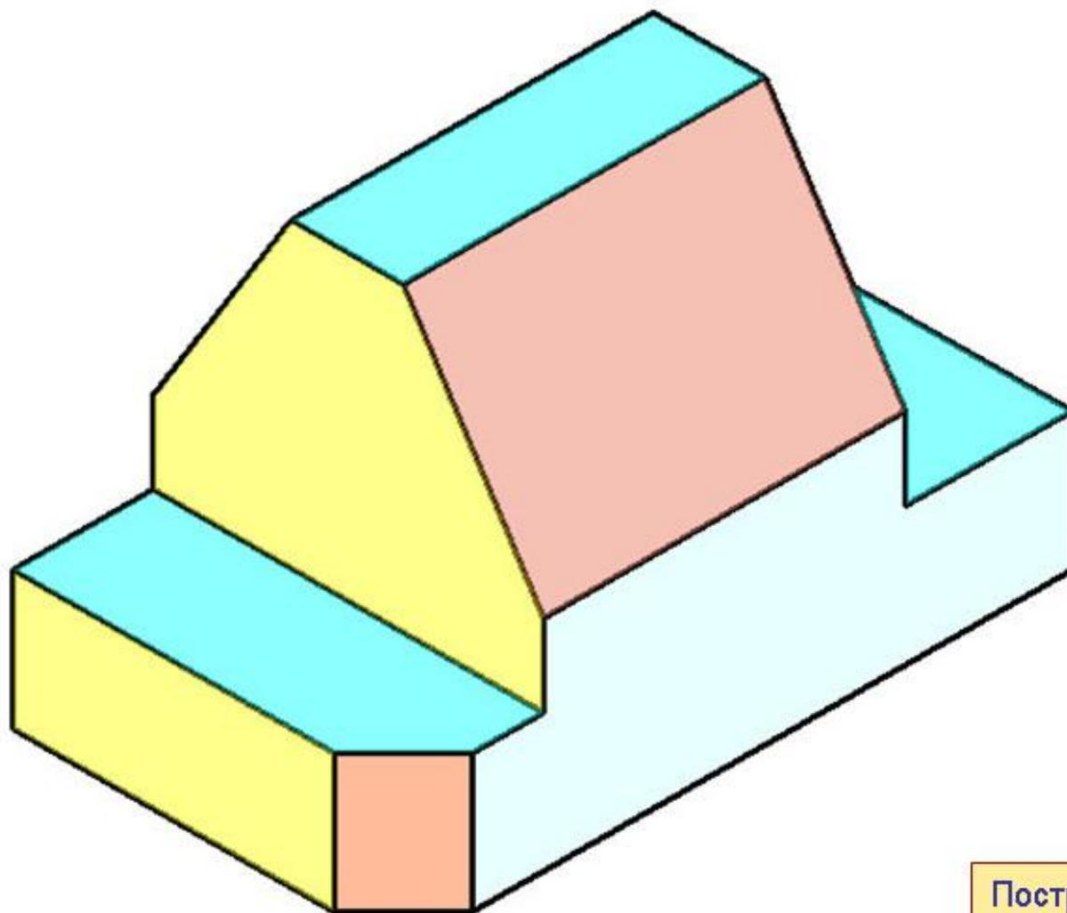
Построим изометрическое изображение детали, а грани раскрашиваем в разные цвета по рисунку.
