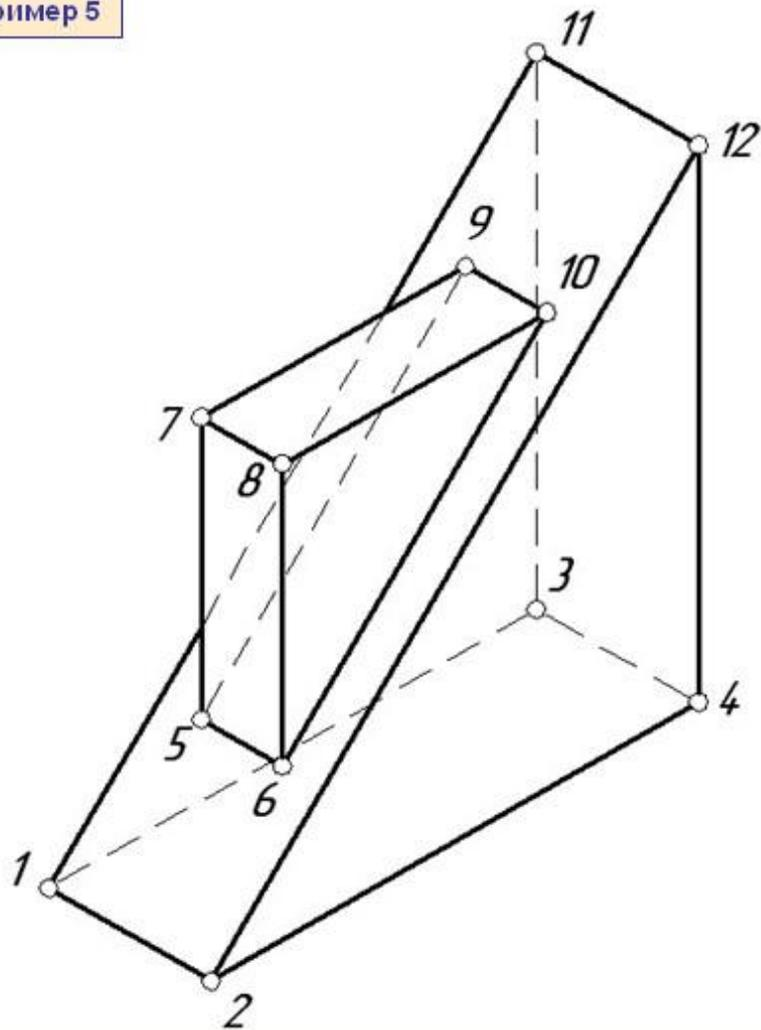
У предмета 10 ребер параллельны горизонтальной плоскости проекций: 1-2; 2-4; 3-4; 1-3; 11-12; 5-6; 9-10; 7-8; 7-9; 8-10.
