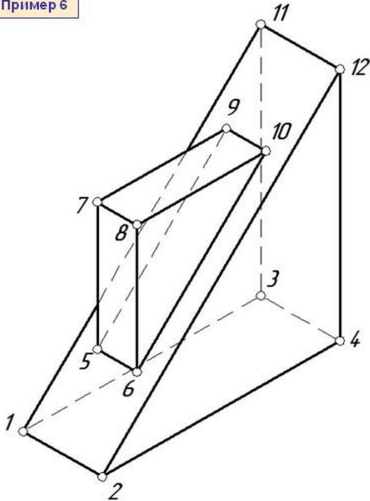
У предмета 2 грани параллельны горизонтальной плоскости проекций: 7-9-10-8; 1-2-3-4. Обозначены в голубой цвет.
