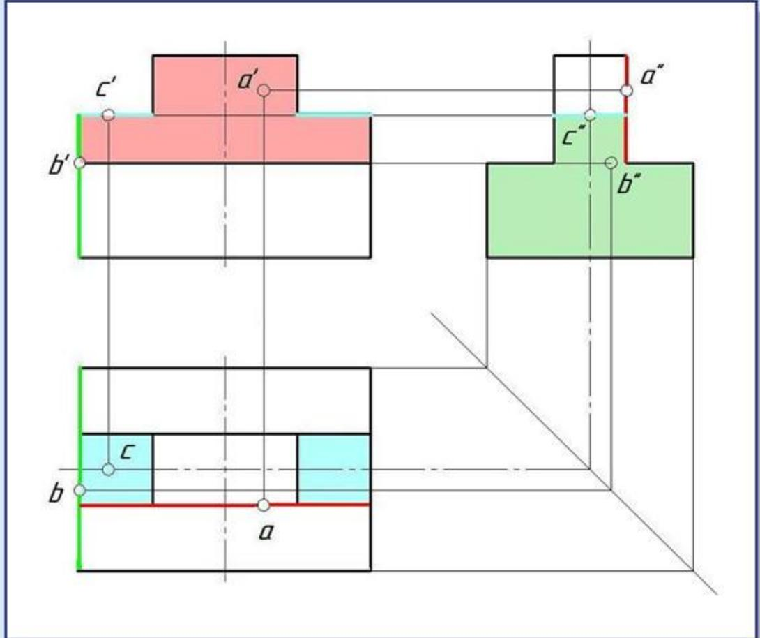
Даны наглядное изображение и три проекции детали. На чертеже показаны проекции точки  $A$ , являющейся одной из вершин детали.
