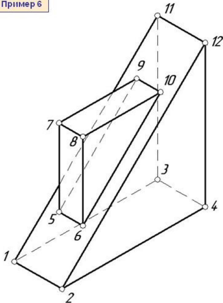
У предмета 4 ребра перпендикулярны горизонтальной плоскости проекций: 7-5; 8-6; 4-12; 11-3, обозначены красным цветом.
