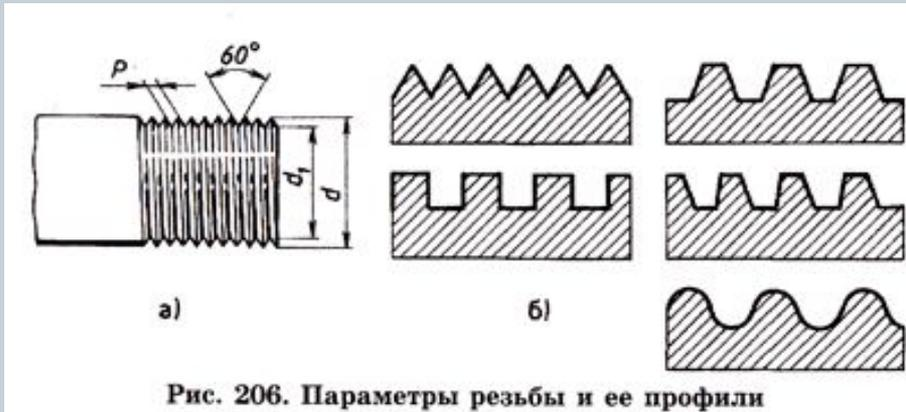
Рис. 206. Параметры резьбы и ее профили
