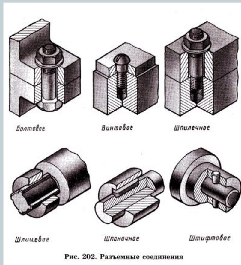
Рис. 202. Разъемные соединения
