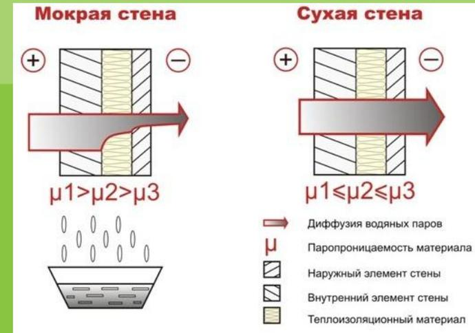
Поэтому ограждающие конструкции должны быть хорошо паропроницаемыми, чтобы выводить из помещения вредные примеси. Такой способностью обладают дома из сруба, поэтому человеку так комфортно и уютно в них, однако у дома из соломы эта способность в 4 раза выше. Солома «дышит» значительно лучше дерева, механизм этого свойства до конца еще не ясен.
