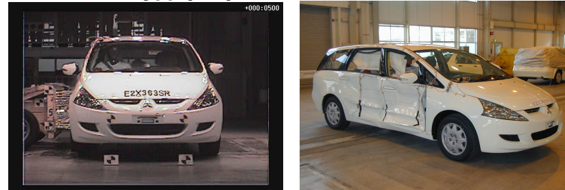
Рис. 2. Оценка безопасности при боковом ударе
