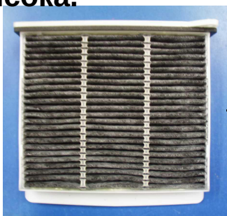
Составной фильтрующий элемент
