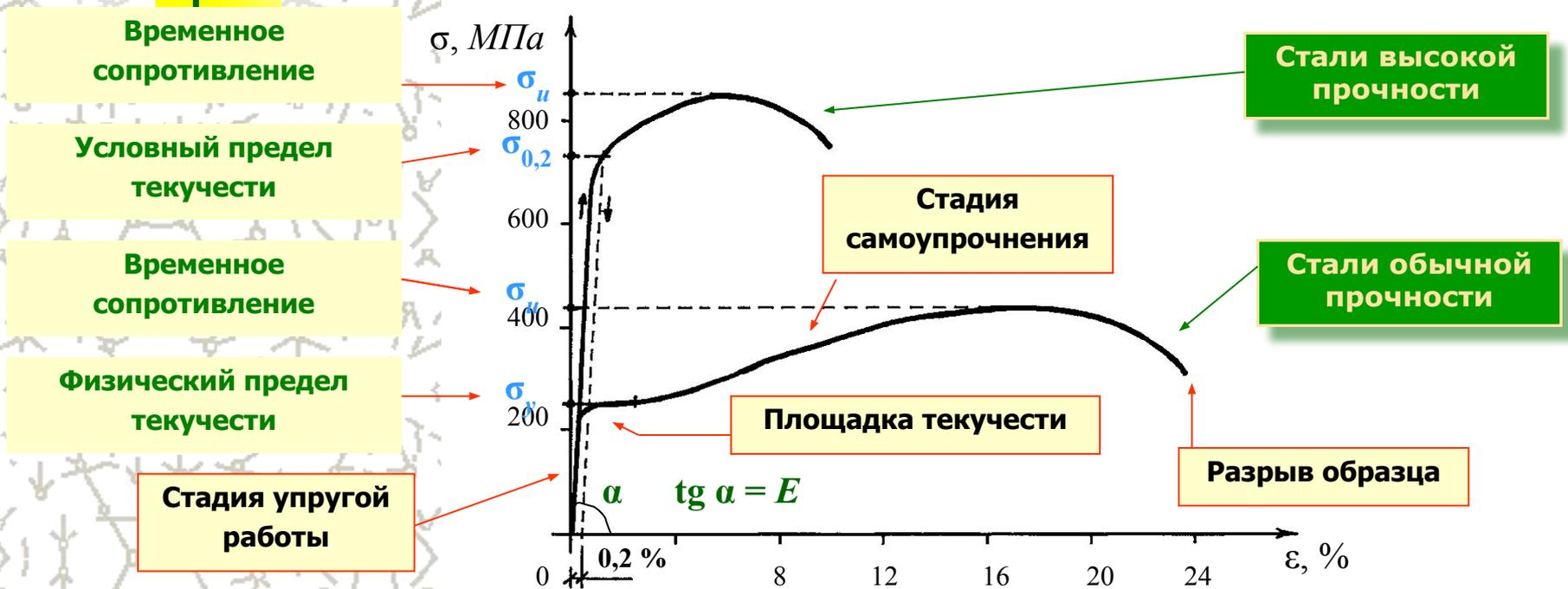
**Физический предел текучести** ( $\sigma_y$ ) – напряжение, при котором происходит рост пластических деформаций без увеличения внешней нагрузки;
