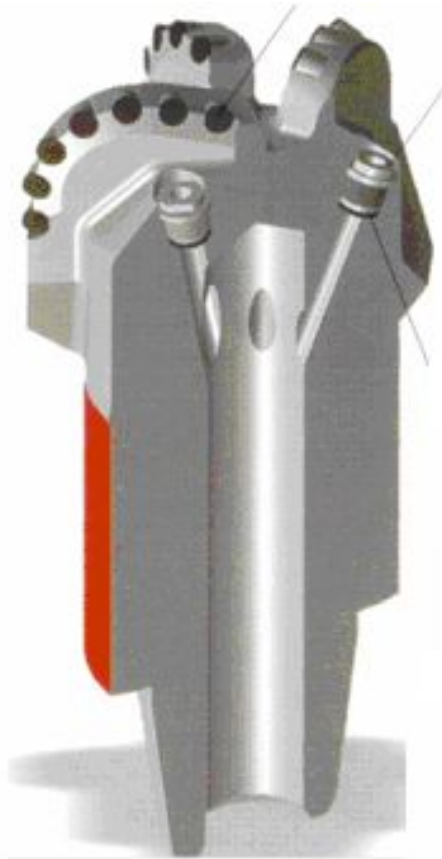
Долота с поликристаллическими алмазными пластинами АТП
