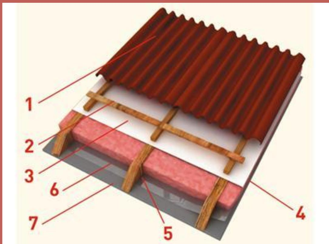
1 – черепица или другой кровельный материал; 2 – шаговая (поперечная) обрешетка; 3 – ветро- и влагозащитная мембрана; 4 – слой утеплителя; 5 – стропила; 6 – слой пароизоляции; 7 – слой внутренней отделки.
