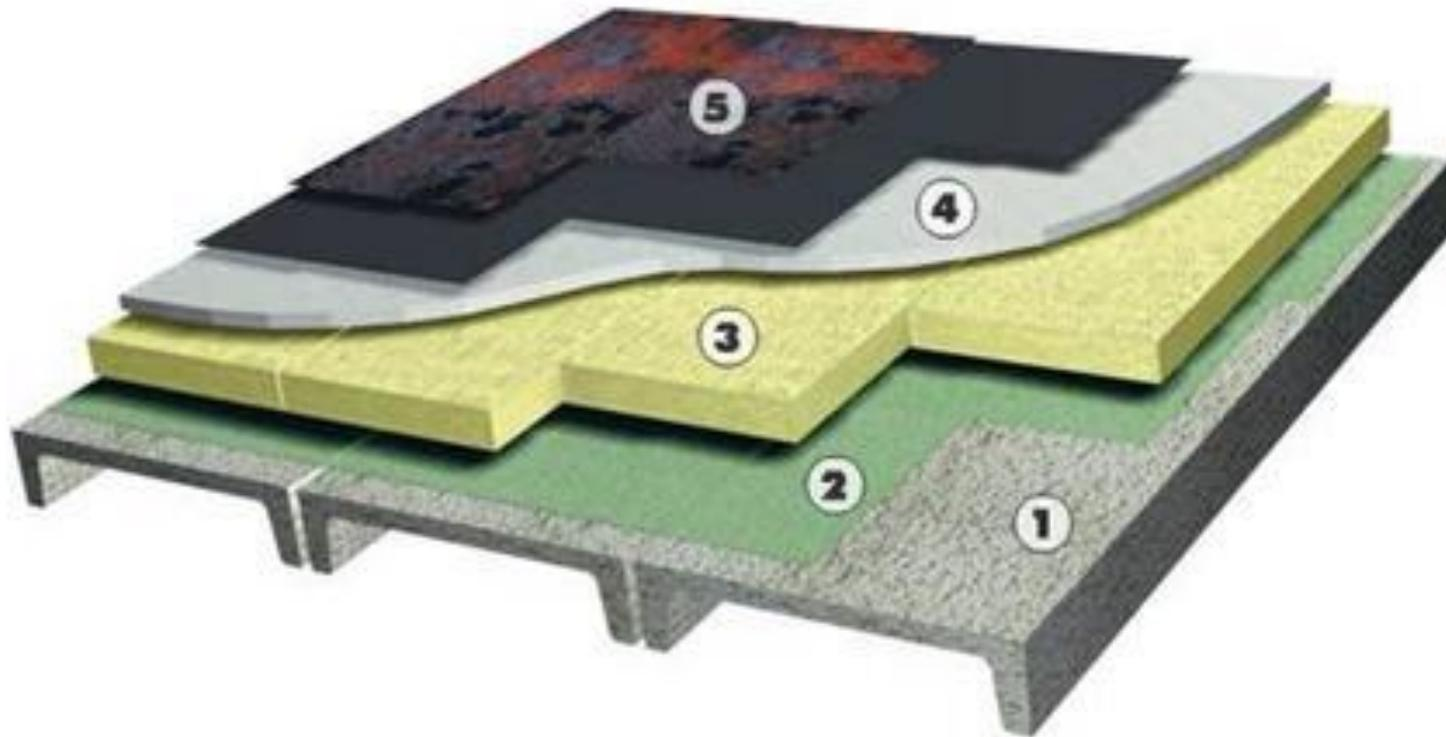
Структура плоской кровли: 1 – плиты покрытия; 2 – слой пароизоляции; 3 – слой утеплителя; 4 – железобетонная стяжка; 5 – слой гидроизоляции (рулонной или наплавляемой)
