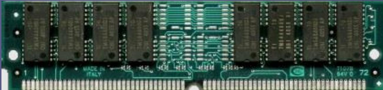
Модули памяти SIMM-72: длина 107,9 мм. Односторонние. Ряды контактов с обеих сторон эквивалентны. Между 36 и 37 контактами расположен ключ (выемка)
