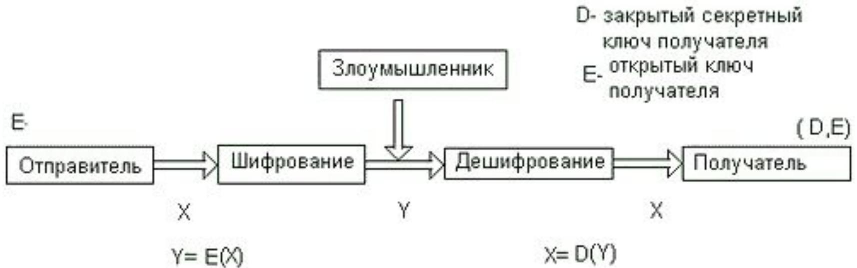
Рис. 6.1. Модель несимметричного шифрования
