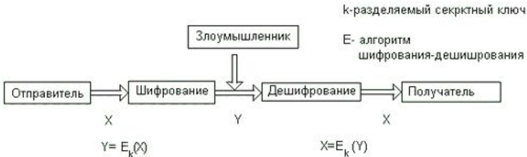
Рис. 6.1. Модель симметричного шифрования
