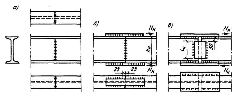
Рис. 7.24. Стыки прокатных балок
