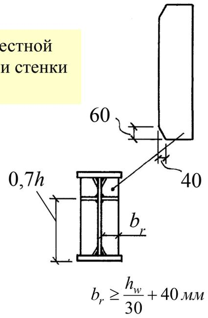
$$b_r \geq \frac{h_w}{30} + 40 \text{ мм}$$
