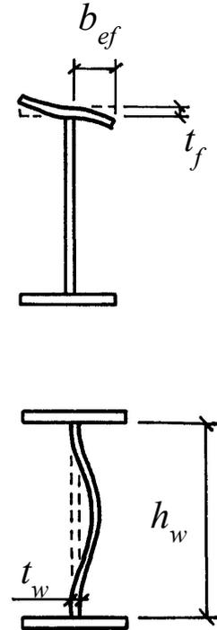
$b_{ef}$  – свес полки;
