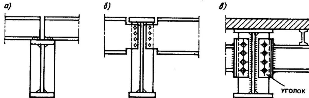
Рис. 7.32. Шарнирные сопряжения балок
