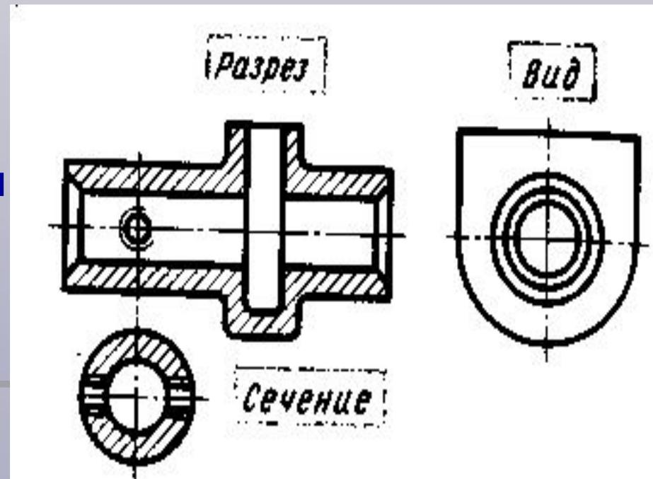
**Сечение** - графическое изображение фигуры, полученное при мысленном рассечении детали плоскостью, попавшее непосредственно в эту плоскость.
