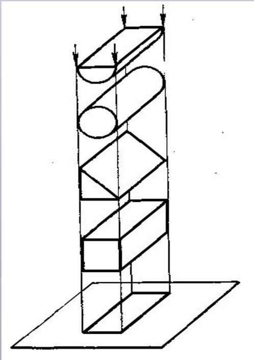
Одинаковую проекцию – прямоугольник - могут иметь цилиндр, призма, параллелепипед, пирамида.
