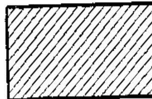
Металлы и твердые сплавы
