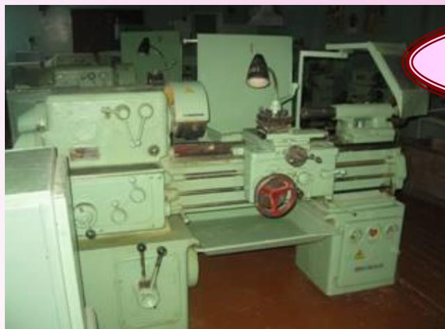
Токарно - винторезный станок 1 А 616
