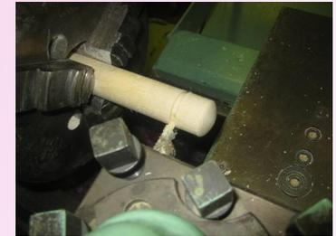
4. Выполнить углубление отрезным резцом на детали диаметром до 10мм
