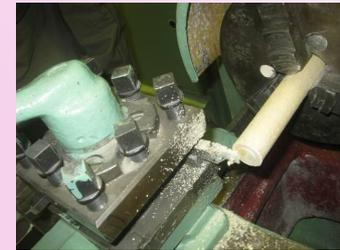
3. Выполнить сферу и отметить длину детали отрезным резцом 22 мм
