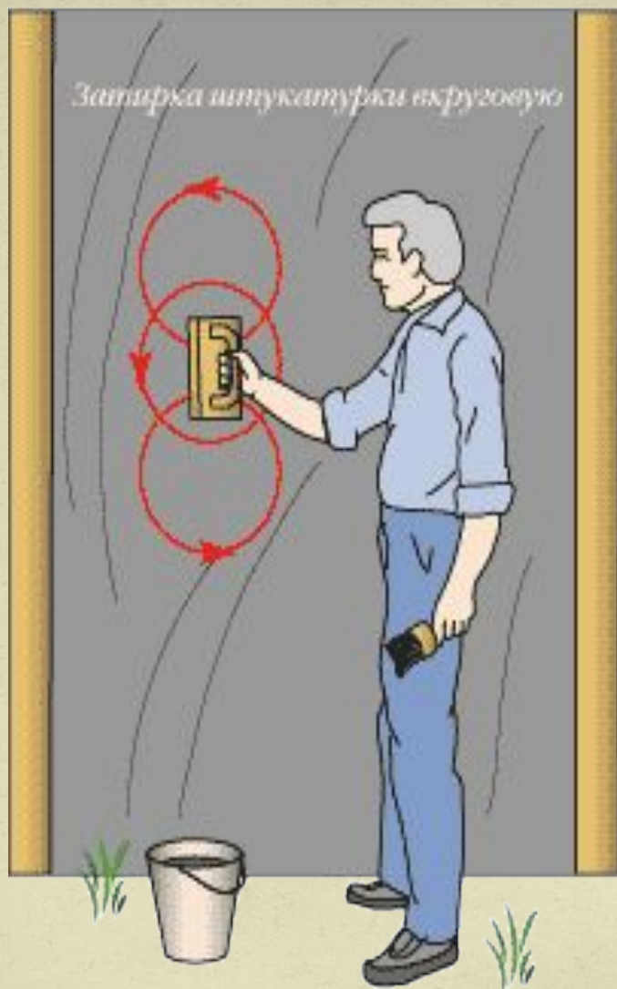
Затирка штукатурки вкруговую и в разгонку
