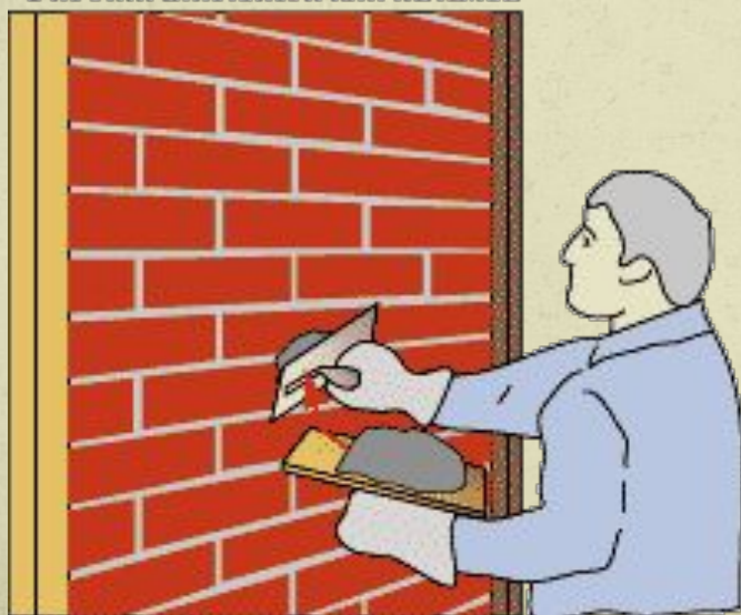
Работа шпательной или сокольной
