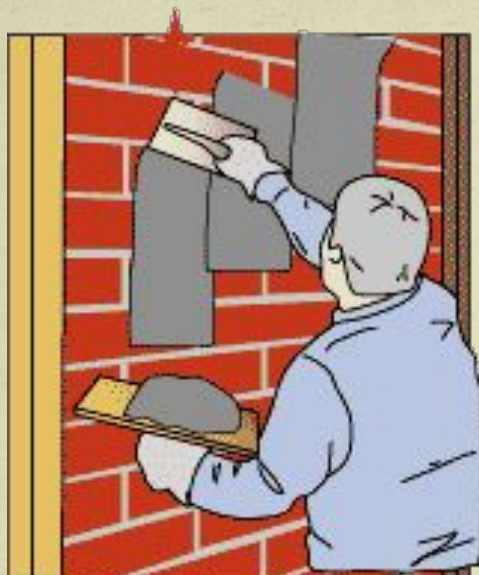
Работа шпательной или сокольной
