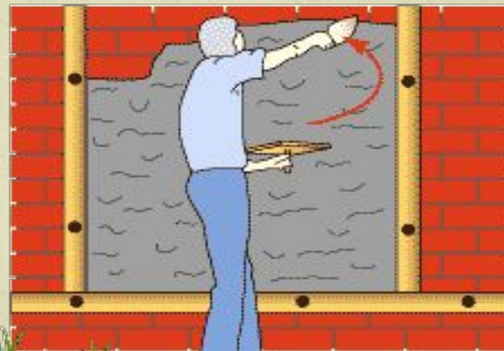
набрасывание смеси на форму
