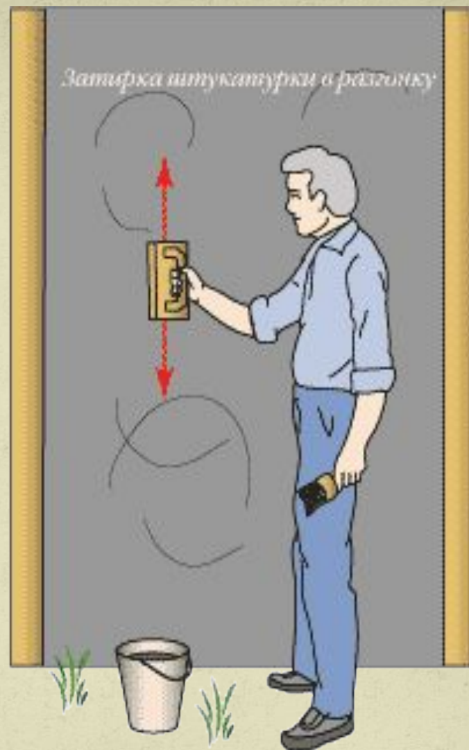
Затирка штукатурки вкруговую и в разгонку
