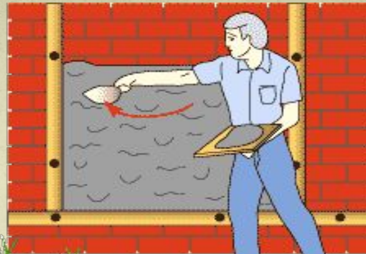
набрасывание смеси на форму
