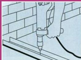
В соответствии с разметкой закрепите профили к полу, стенам и потолку. Отверстия проделать при помощи электродрели
