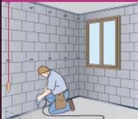
Расстояние по вертикали между подвесами не должно превышать 1,5 м. По горизонтали шаг установки прямых подвесов должен соответствовать шагу ПП и составлять 600 мм. С целью улучшения звукоизоляции на тыльную сторону прямого подвеса приклеивают ленту.
