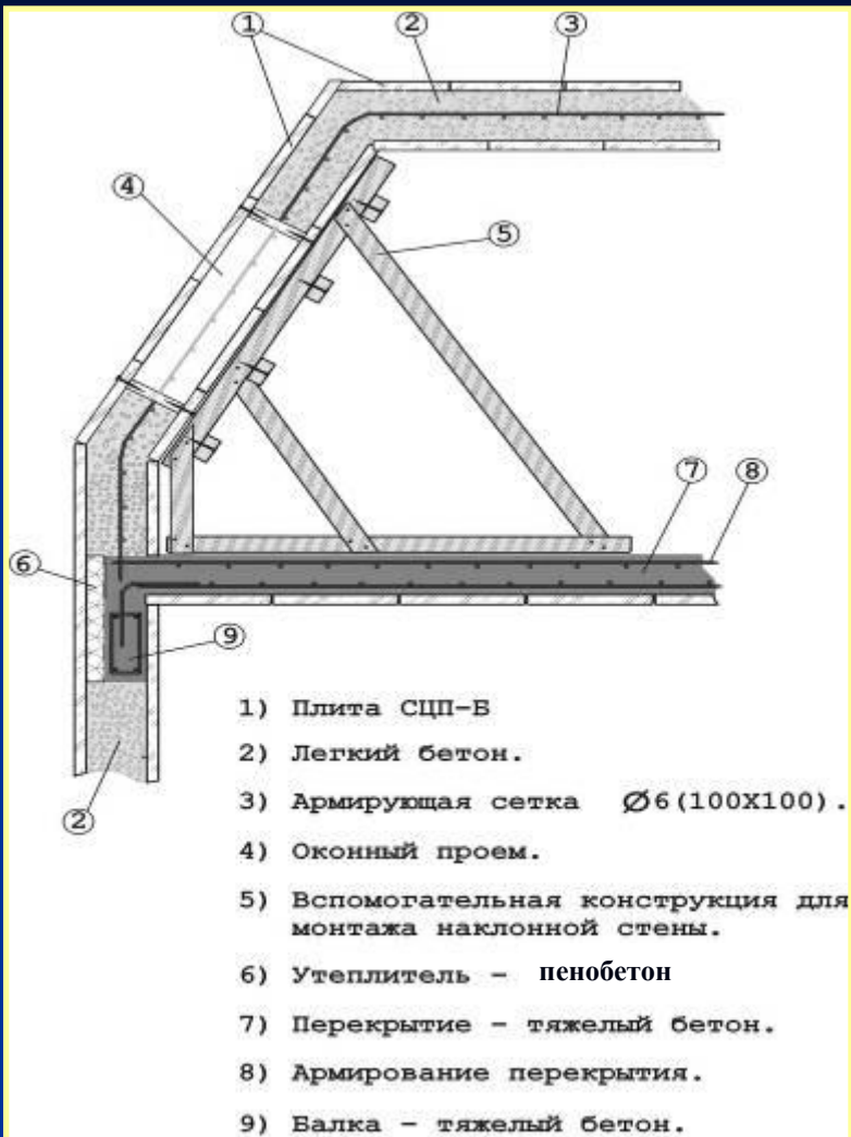
Рис.5 Сечение стены мансардного этажа
