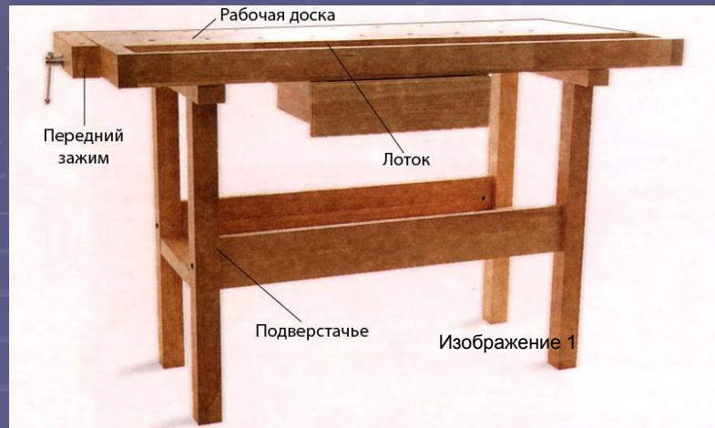
С его помощью вращением рукоятки ходового винта, которое вызывает перемещение прижимного бруска, можно закреплять или освобождать обрабатываемую деталь.
