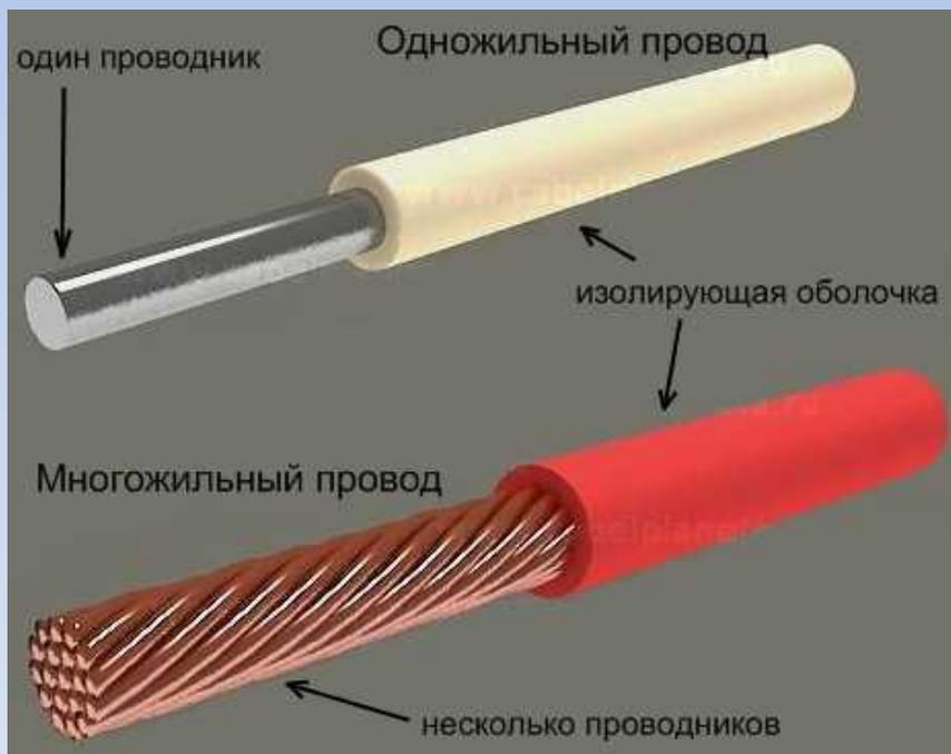
Электрические провода бывают без изоляции (голые) и с изоляционным покрытием.
