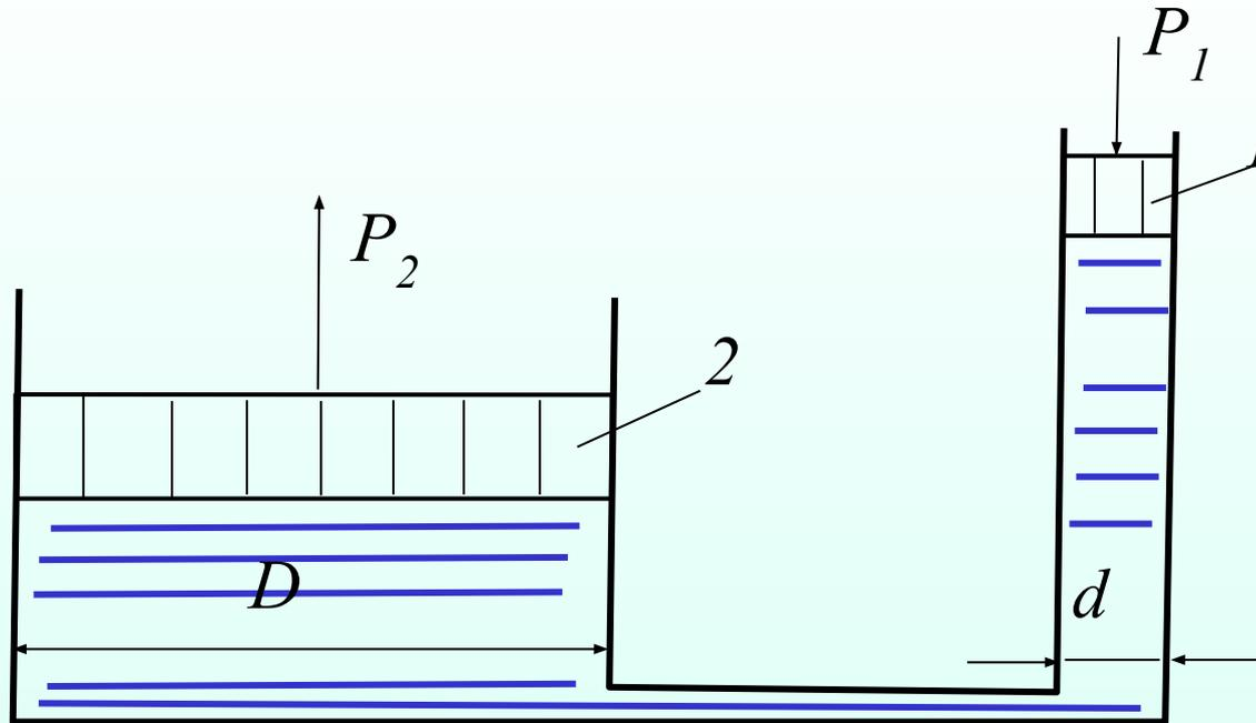
Рисунок 7 – Схема гидравлического пресса
