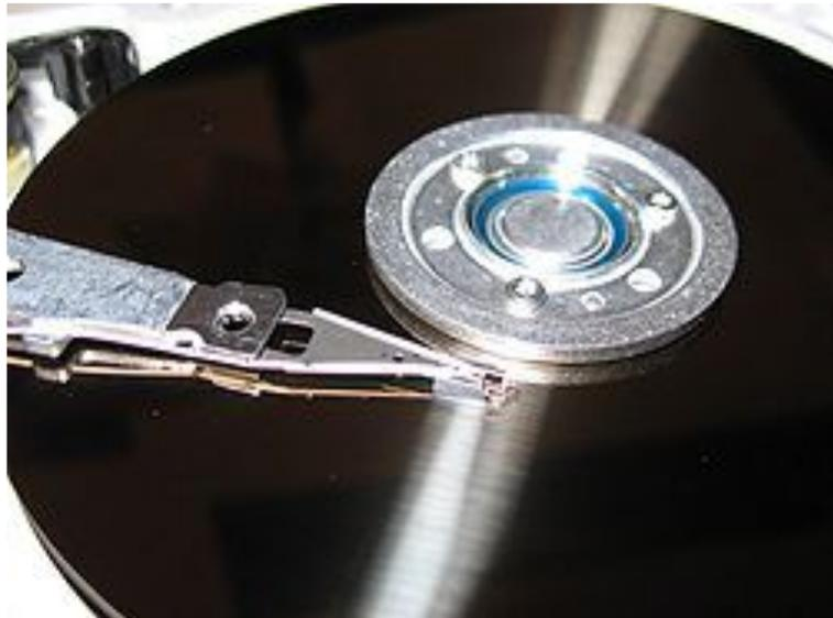
Магнит линейного двигателя, который перемещает головку жёсткого диска.
