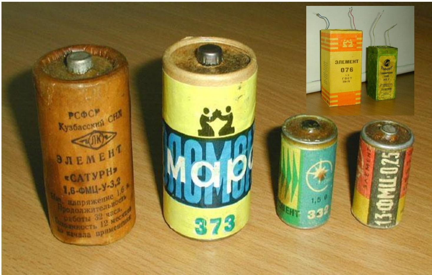
**Из нескольких гальванических элементов можно составить *батарею*.**
