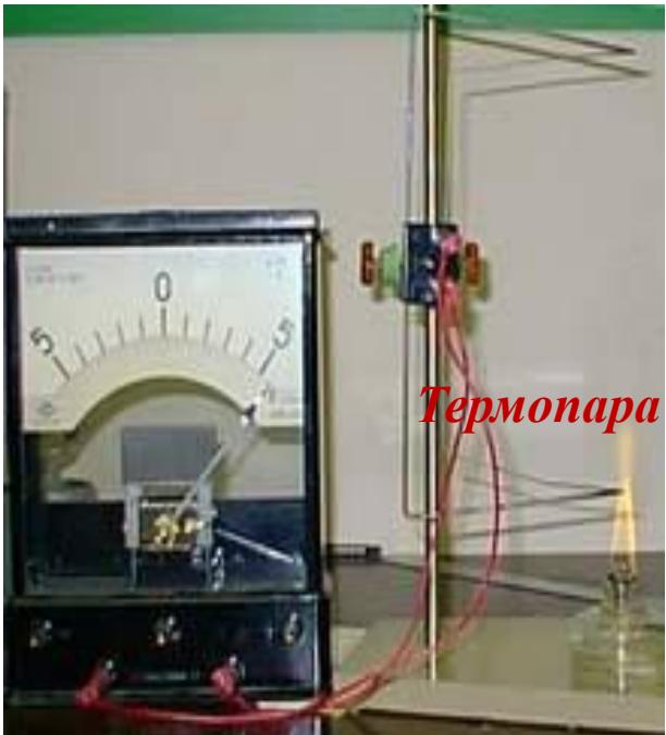
Если две проволоки из разных металлов спаять с одного края, а затем нагреть место спая, то в них возникает ток – заряды при нагревании спая разделяются. Термоэлементы применяются в термодатчиках и на геотермальных электростанциях в качестве датчика температуры.
