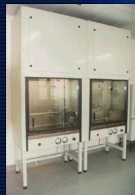
Вытяжной шкаф - это специальное лабораторное оборудование для проведения работ с открытыми радиоактивными веществами. Благодаря своей конструкции и способу обслуживания, он служит для защиты работающих от облучения, радиационного загрязнения и радиоактивных выбросов в окружающую среду.
