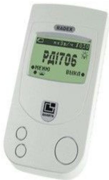
Индикатор радиоактивности РАДЭКС РД1503 (RADEX RD1503) предназначен для обнаружения и оценки уровня ионизирующего излучения, в том числе и радона. Он производится на предприятии ООО «Кварта-Рад» по адресу: Россия, г. Москва. С помощью этого прибора мною был замерен уровень радона в школе, где я учусь. Содержание газа в воздухе оказалось в пределах нормы.
