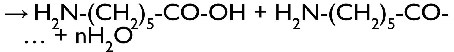
Процесс ведется в присутствии воды, играющей роль активатора, при температуре 240-270° С и давлении 15-20 кгс/см<sup>2</sup> в атмосфере азота.
