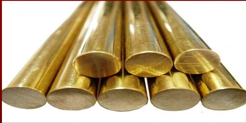
Для лучшей обрабатываемости в бронзу вводят от трех до пяти процентов свинца, который присутствует в виде обособленных включений, обеспечивающих ломкость стружки при ее обработке на металлорежущих станках. Фосфор вводится в бронзу как раскислитель и устраняет хрупкие включения окиси олова. При наличии около одного процента фосфора такую бронзу принято называть фосфористой. Фосфор при его содержании более 0,2 процента образует твердые включения, повышая антифрикционные свойства бронзы.
