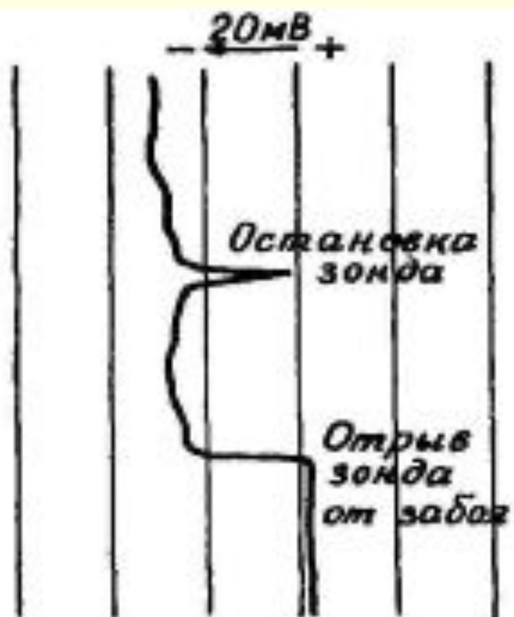
Рис. 11.3. Проявление помех от трибополяризации на диаграмме ПС
