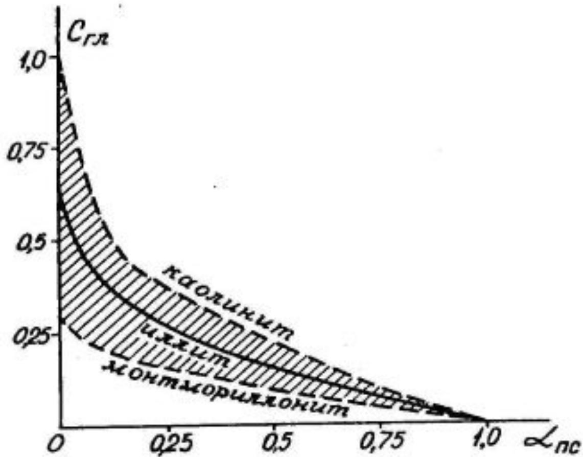
Рис. 11.7. Определение глинистости водонасыщенных песчаников по параметру  $\alpha_{пс}$
