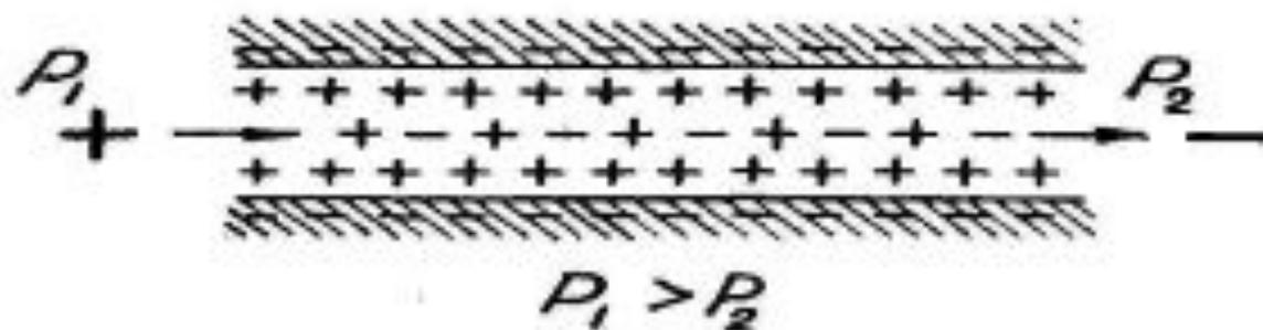
Рис. 10.6. Схема возникновения фильтрационных потенциалов
