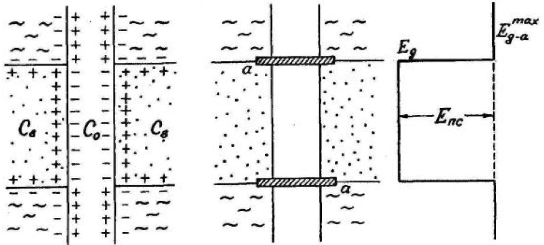
Рис. 10.2. Возникновение диффузионно-адсорбционной ЭДС в скважине при "прямом" поле ( $c_0 < c_s$ )
