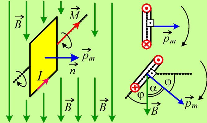
Перейдем к модулю вращательного момента сил, действующих на рамку с током со стороны магнитного поля:
