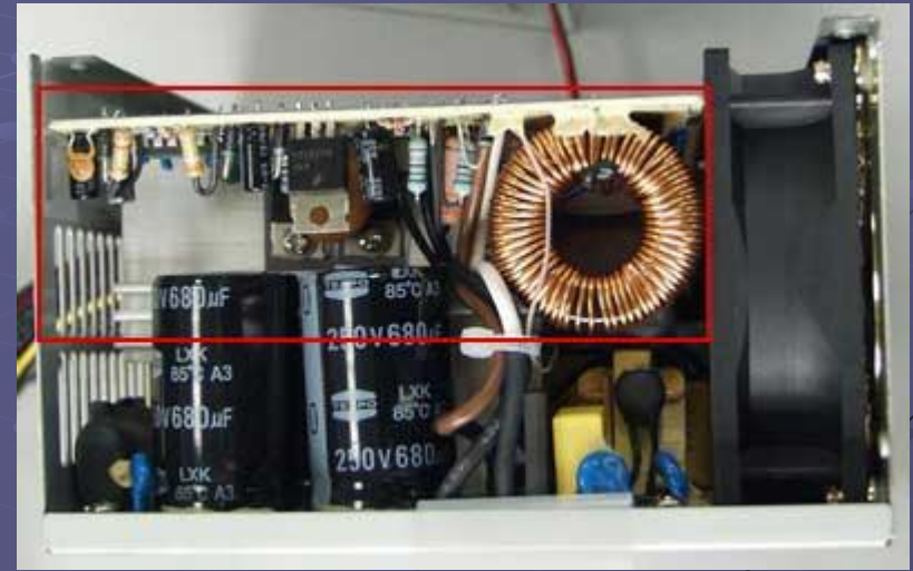
Плата активного PFC (Thermaltake PurePower HPC-420-302DF)
