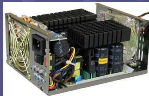
Пример массивных радиаторов
