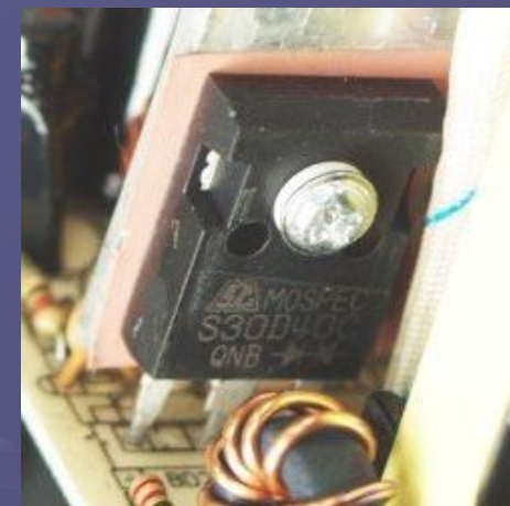
Диодная сборка MOSPEC (30А)
