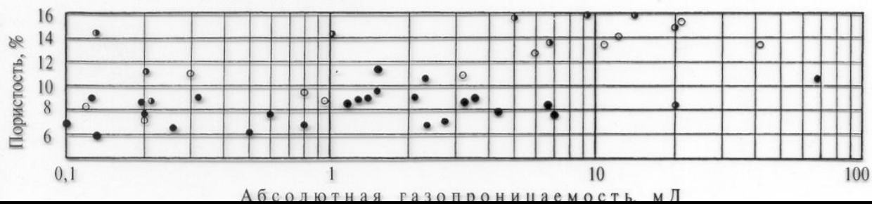
Рис. 8 Соотношение пористости и газопроницаемости в коллекторах порового типа. Месторождение Тенгиз.
