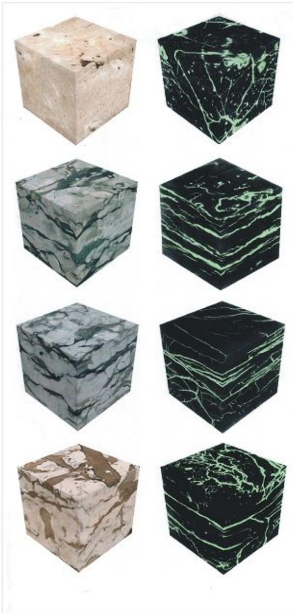
Система тонких наклонных трещин в перекристаллизованном известняке Урманское нефтяное месторождение (Нюрольская впадина)
