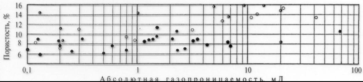
Рис. 8 Соотношение пористости и газопроницаемости в коллекторах порового типа. Месторождение Тенгиз.
