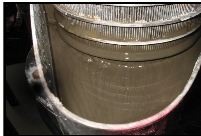
Подача материала измельчения через грохот и гидравлическое регулирование
