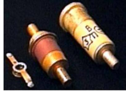
Сверхвысокочастотный диод — полупроводниковый диод, предназначенный для работы в сантиметровом диапазоне волн. Диод содержит между двумя сильно легированными областями высокой проводимости  $n+$  и  $p+$  активную базовую  $i$ -область с низкой проводимостью и большим временем жизни носителей заряда, то есть  $p-i-n$ -переход. Это позволяет снизить его емкость и повысить частоту работы элемента.
