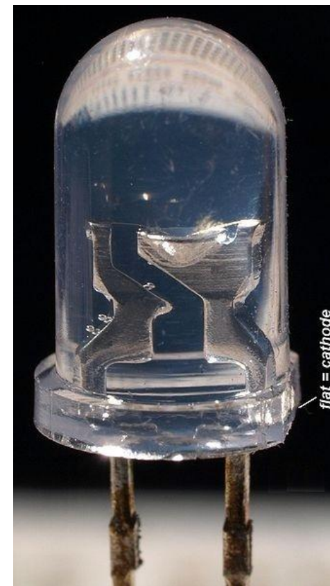
Светодиод в пластиковой оболочке
