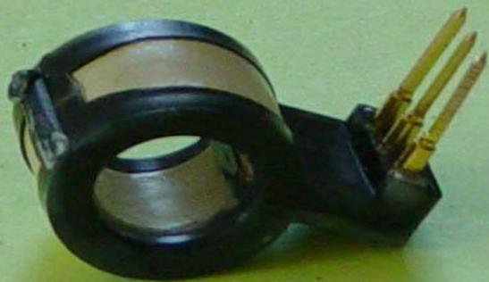
Датчик Холла, используемый для измерения силы тока в проводнике. В отличие от трансформатора тока, измеряет также и постоянный ток.
