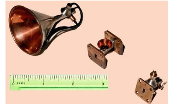
Электрически управляемые генераторы на диоде Ганна
