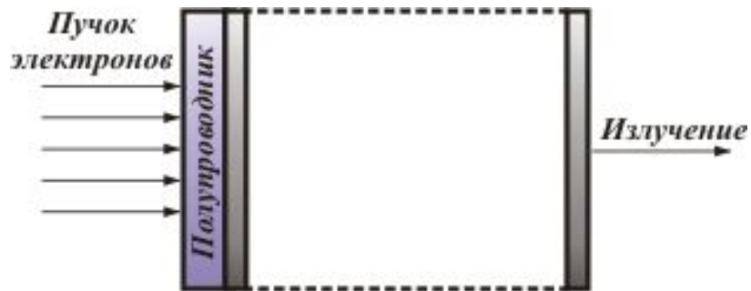
Продольная накачка электронным пучком
