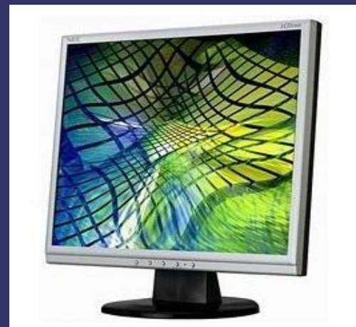
В жидкокристаллических мониторах изображение строится по принципу прохождения света через слой содержащий жидкие кристаллы (Liquid Crystal), которые при воздействии электрического сигнала поворачиваются определенным образом и пропускают свет одного вектора поляризации, т.е. какой-то один цвет из спектра.
