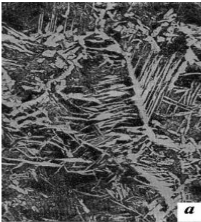
а - видманштеттова структура литой доэвтектоидной стали
