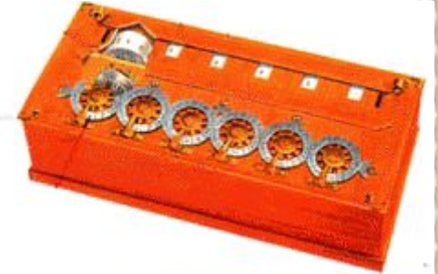
Арифметическая машина Б. Паскаля
