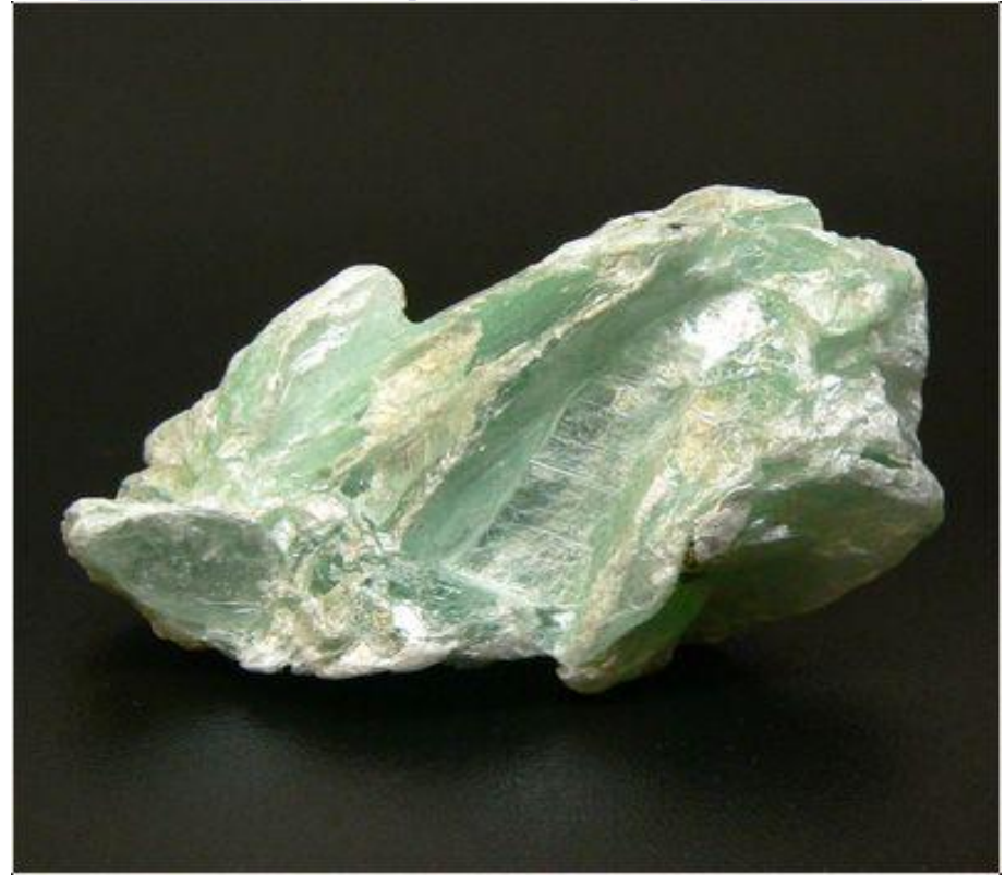
3\text{MgO} \cdot 4\text{SiO}_2 \cdot 4\text{H}_2\text{O} (тальк)
