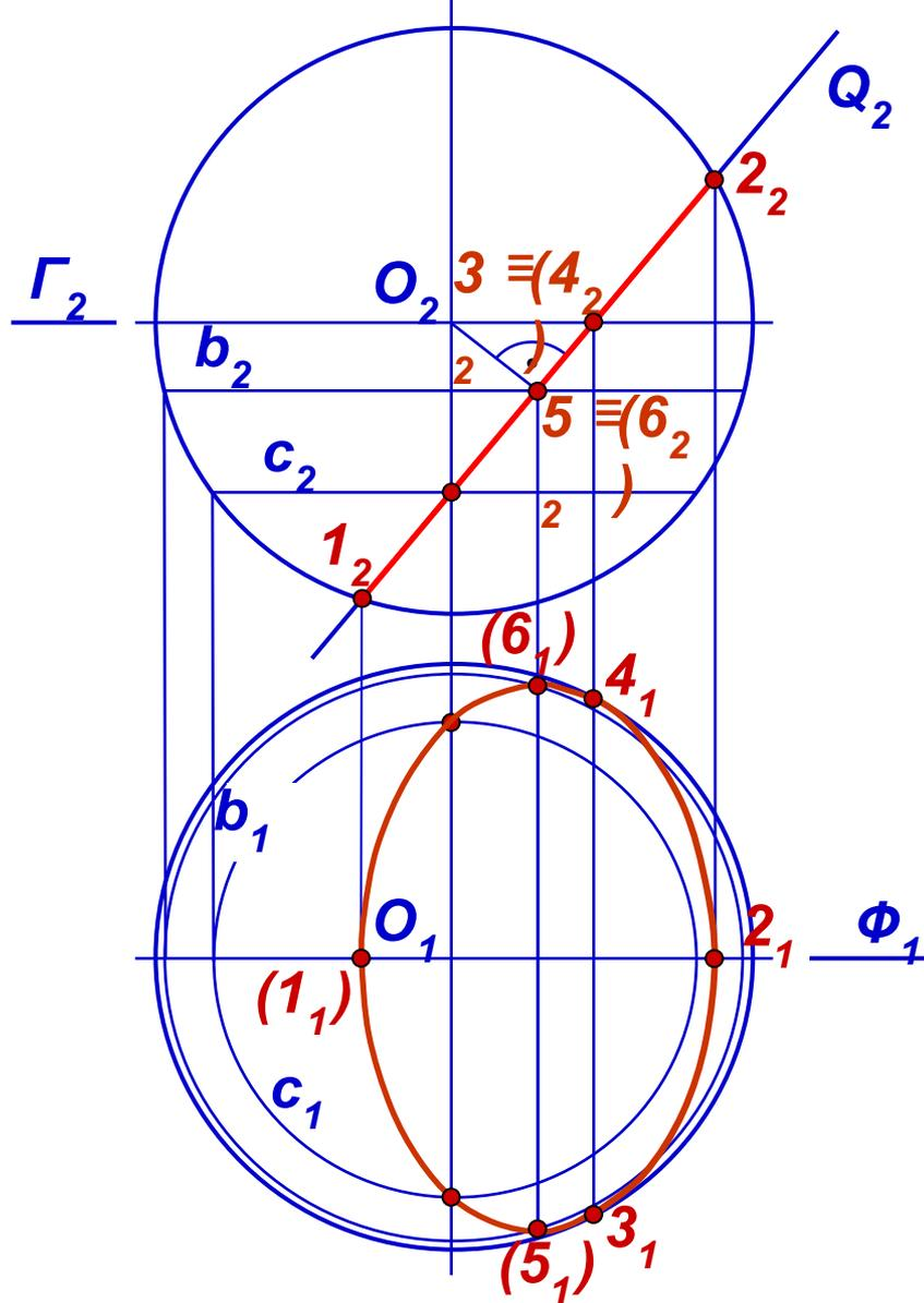
Объединяем все построенные на  $\Pi_1$  точки в линию (эллипс) с учетом ее видимости относительно сферы. Видимость линии будет меняться в точках  $3_1$  и  $4_1$ , построенных заранее в соответствии с алгоритмом решения задачи.
