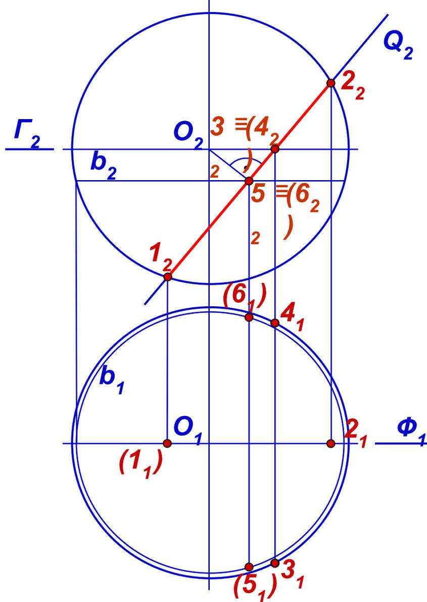
Экстремальные точки эллипса (высшую и низшую) находим, разделив пополам отрезок  $1_2 2_2$  перпендикуляром, опущенным из точки  $O_2$ . В основании перпендикуляра фиксируем две совпадающие проекции точек ( $5_2$  и  $6_2$ ). На  $\Pi_1$  проекции  $5_1$  и  $6_1$  располагаем на параллели  $b_1$  как невидимые.
