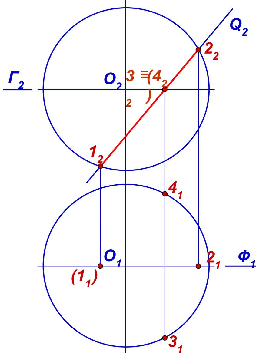
С помощью плоскости  $\Gamma$  ( $\Gamma_2$ ) зафиксируем совпадающие проекции точек ( $3_2$  и  $4_2$ ) на пересечении  $\Gamma_2$  со следом заданной плоскости  $Q_2$ . Проекции  $3_1$  и  $4_1$  располагаем на горизонтальном очерке сферы – экваторе. Это будут точки изменения видимости линии сечения на  $\Pi_1$ .
