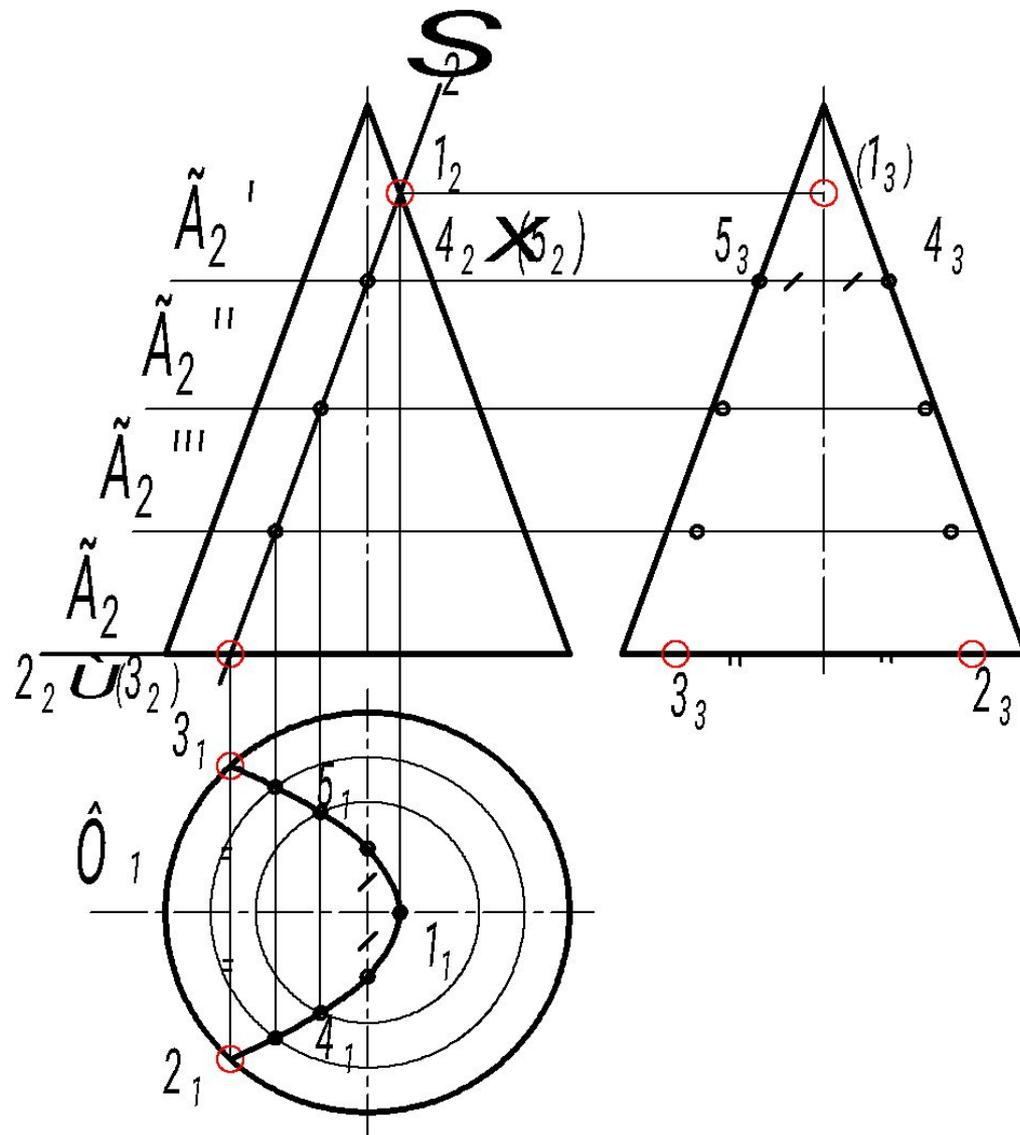
Промежуточные точки (без обозначения) линии сечения строим с помощью плоскостей  $\Gamma''$  и  $\Gamma'''$ . На  $\Pi_1$  объединяем все точки в проекцию линии сечения.
