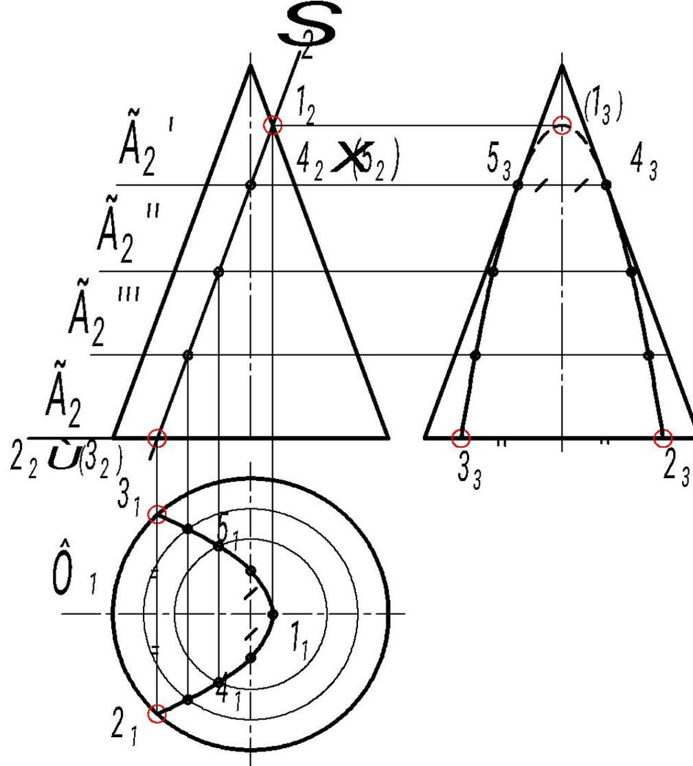
При объединении точек параболы на ПЗ следует учитывать её видимость относительно конуса. Видимость линии изменяется в точках 4 и 5, построенных в соответствии с алгоритмом решения.
