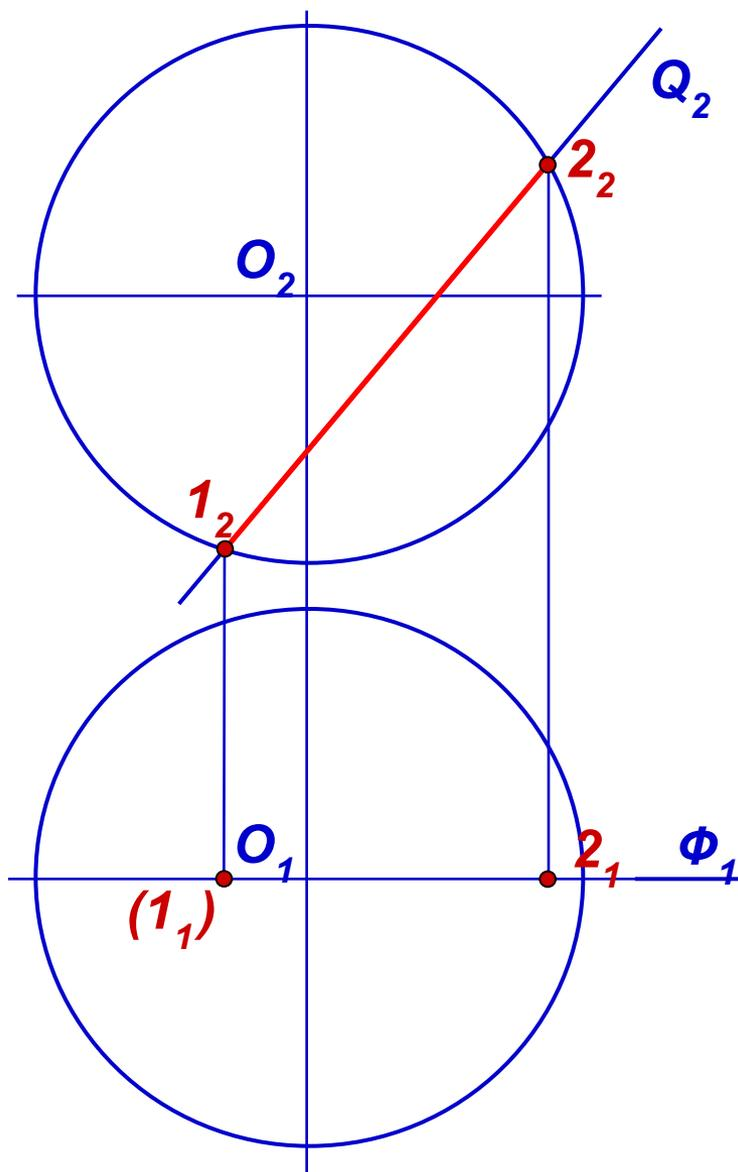
При построении линии сечения сферы плоскостью частного положения  $Q(Q_2)$  прежде всего находим на  $\Pi_2$  проекции экстремальных точек. Это точки пересечения следа  $Q_2$  с очерком сферы –  $1_2$  и  $2_2$ . На  $\Pi_1$  проекции  $1_1$  и  $2_1$  располагаем на следе плоскости  $\Phi_1$  с учетом их видимости.
