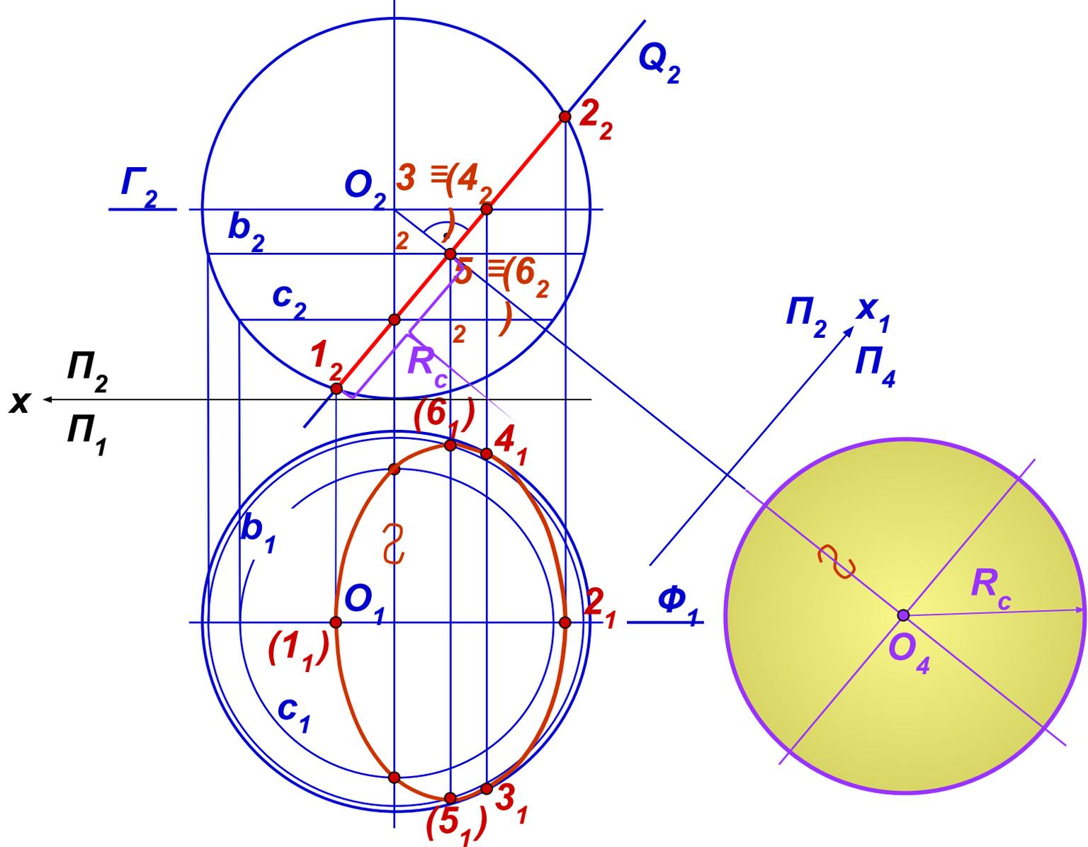
На дополнительной плоскости проекций  $\Pi_4$  линия сечения – окружность проецируется в натуральную величину.
