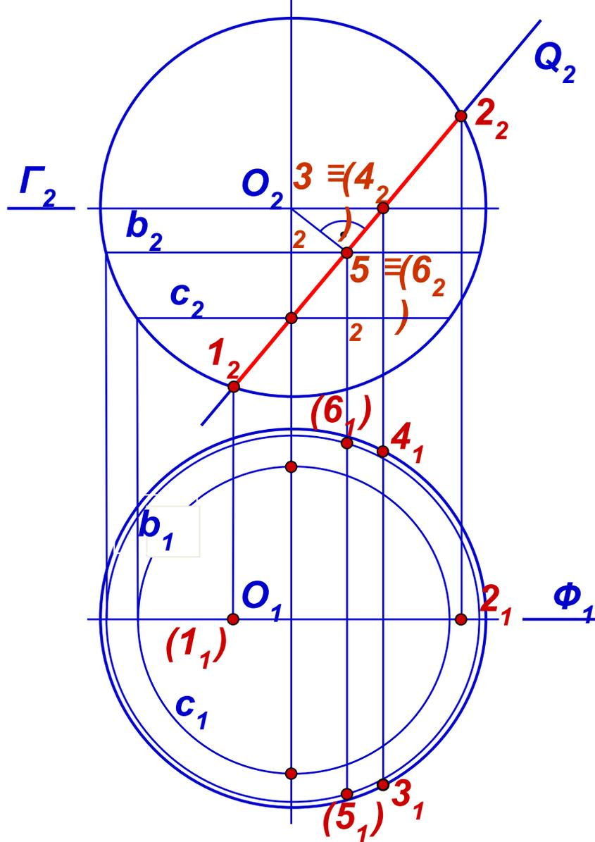
Для уточнения формы кривой – эллипса находим промежуточные точки ( на чертеже не обозначены). Совпадающие точки фиксируем произвольно на следе  $Q_2$  и переносим их на  $\Pi_1c$  помощью параллели  $s$ .
