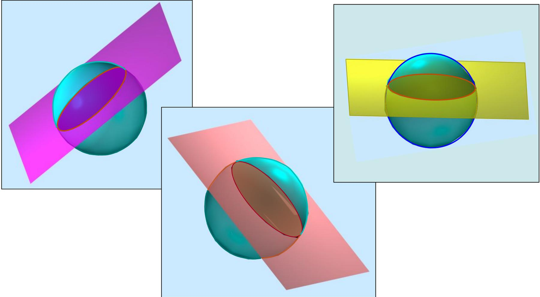
**Любая плоскость пересекает сферу по окружности. Окружность на плоскость проекций может проецироваться в натуральную величину (плоскость уровня), в виде отрезка, равного диаметру (проецирующая плоскость) и в виде эллипса (плоскость общего положения)**
