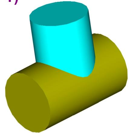
Геометрическое место точек, принадлежащее одновременно двум поверхностям, называют линией пересечения данных поверхностей
