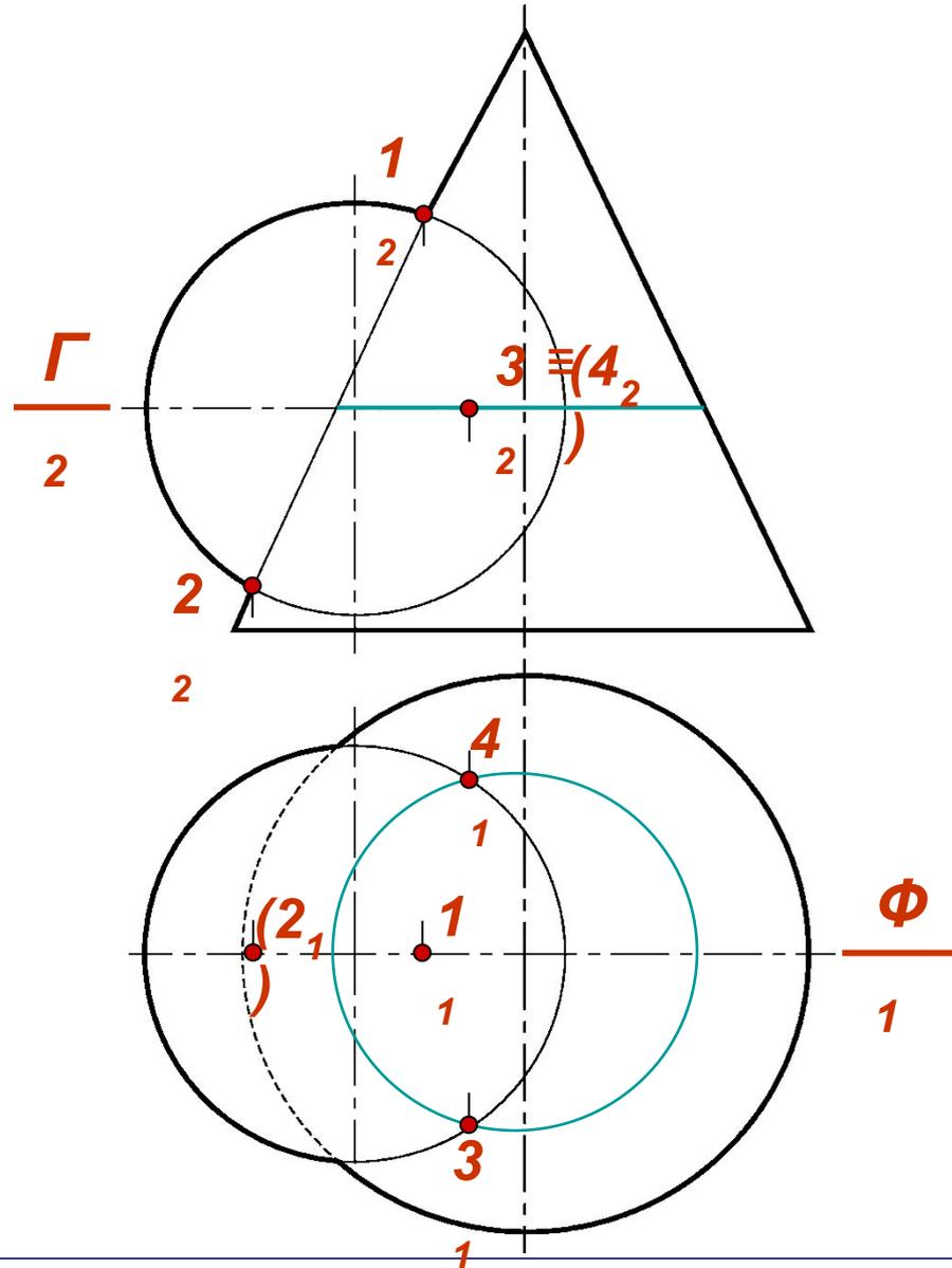
Точки изменения видимости линии на  $\Pi_1$ , лежащие на экваторе сферы, находим с помощью плоскости  $\Gamma$  ( $\Gamma_2$ ). На  $\Pi_1$  это будут точки пересечения экватора сферы с соответствующей параллелью конуса -  $3_1$  и  $4_1$ . На  $\Pi_2$  проекции точек ( $3_2$  и  $4_2$ ) располагаем на следе плоскости ( $\Gamma_2$ ).
