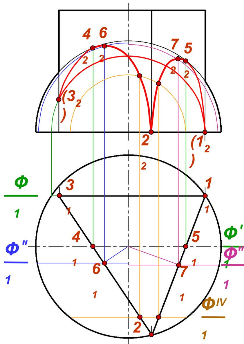
На  $\Pi_2$  объединяем все построенные  $1^{\circ}$  точки в участки - эллипсы линии пересечения, а на  $\Pi_1$  вся линия совпадает с очерком проецирующей призмы. При обводке эллипсов на  $\Pi_2$  следует учитывать, что проекции точек (4<sub>2</sub> и 5<sub>2</sub>), лежащих на меридиане сферы, изменяют видимость эллипсов.
