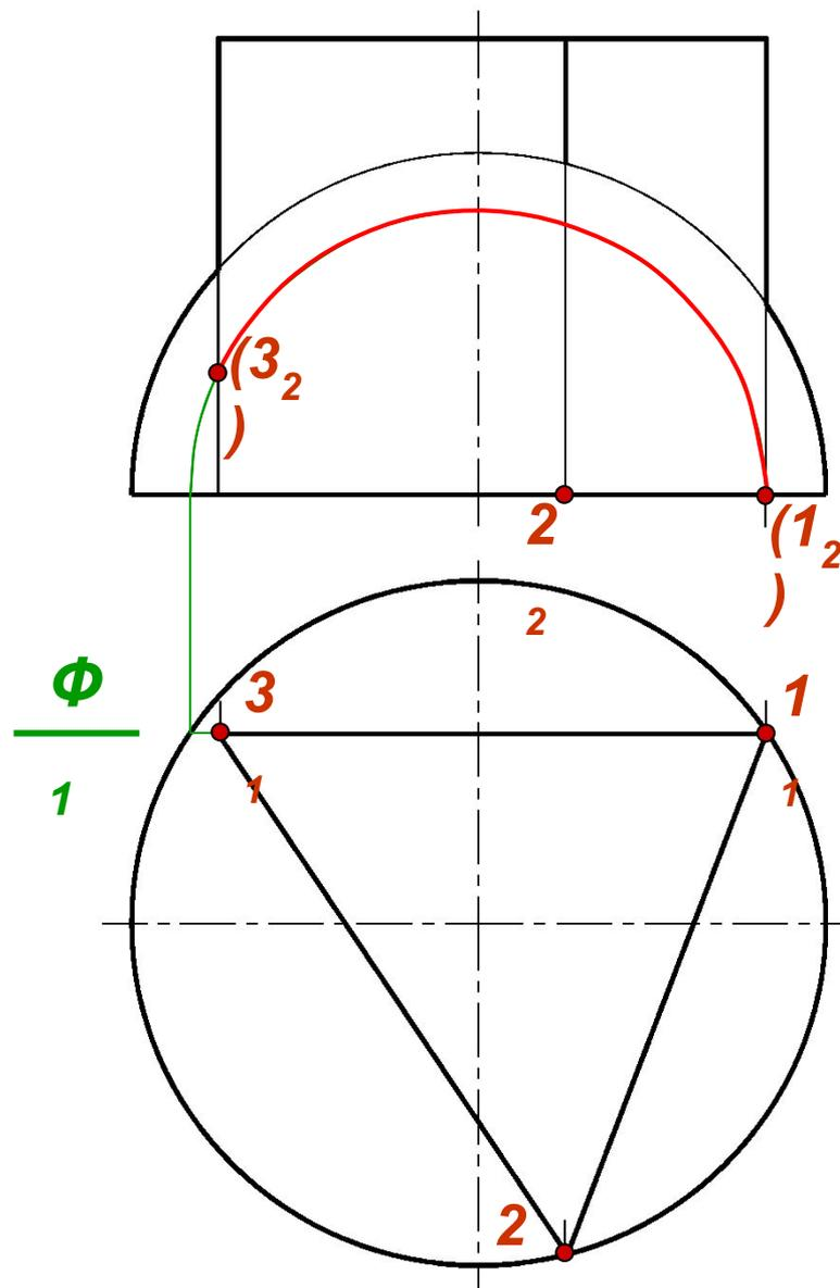
Фиксируем на  $\Pi_1$  проекции точки пересечения ребер призмы с поверхностью сферы ( $1_1$ ,  $2_1$  и  $3_1$ ). На  $\Pi_2$  проекции  $1_2$  и  $2_2$  находим на экваторе сферы, а  $3_2$  - на параллели, полученной с помощью плоскости  $\Phi(\Phi_1)$ . Часть параллели между  $3_2$  и  $4_2$  будет первым участком искомой линии.
