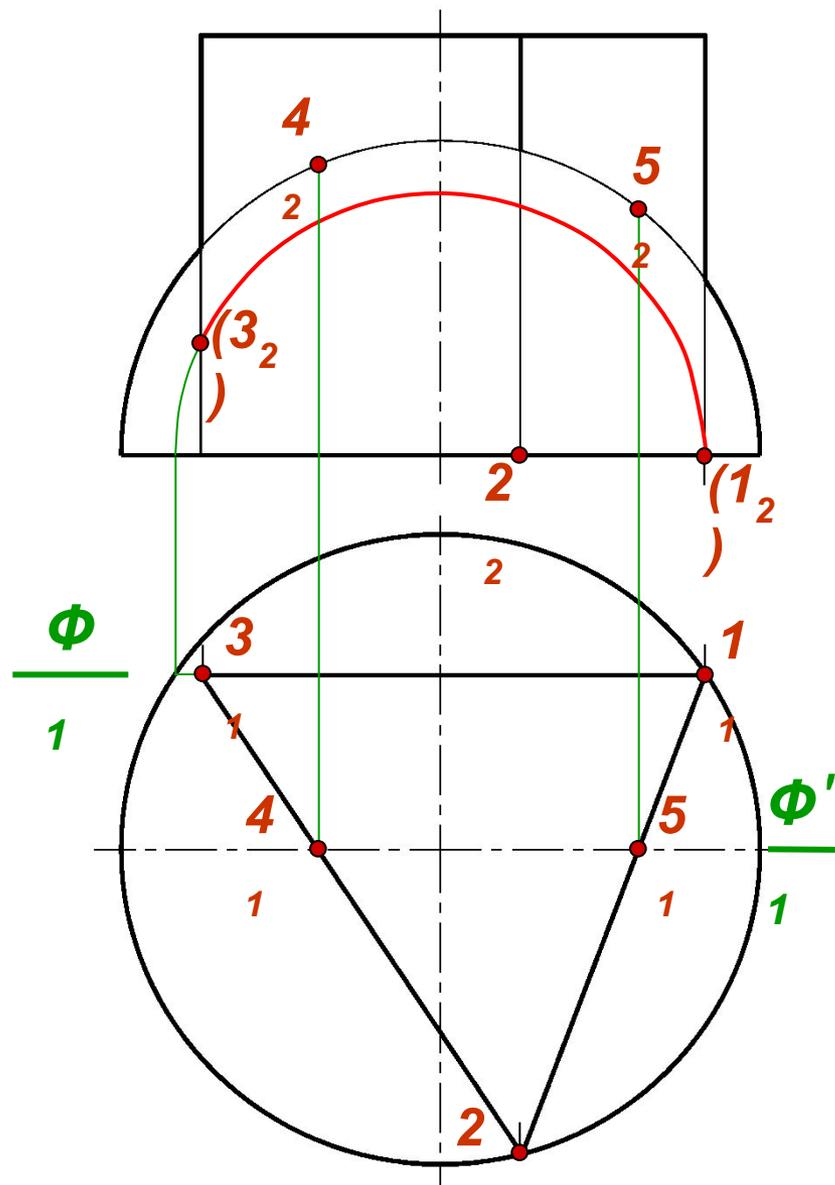
На  $\Pi_1$  проекции 4<sub>1</sub> и 5<sub>1</sub> фиксируем как <sup>1</sup> точки пересечения меридиана сферы, лежащего в плоскости  $\Phi'$  ( $\Phi_1'$ ), с гранями призмы. Фронтальные проекций указанных точек (4<sub>2</sub> и 5<sub>2</sub>) располагаем на меридиане сферы. Это будут точки, меняющие видимость линии пересечения на  $\Pi_2$ .
