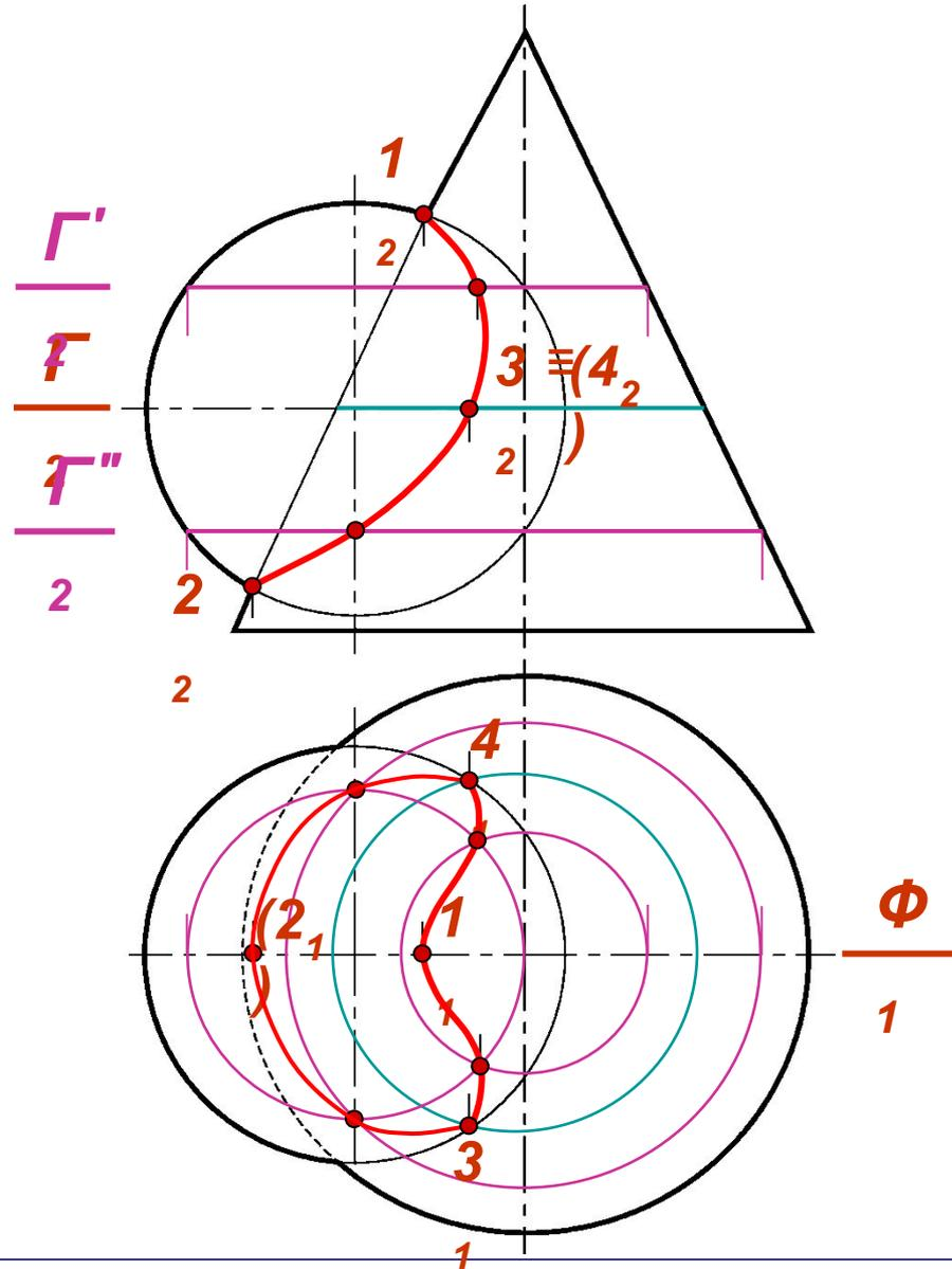
При соединении проекций точек на горизонтальной плоскости проекций выявляют видимый и невидимый участки линии пересечения. Эти участки разделяются проекциями точек перемены видимости - 31 и 41, лежащими на экваторе сферы.
