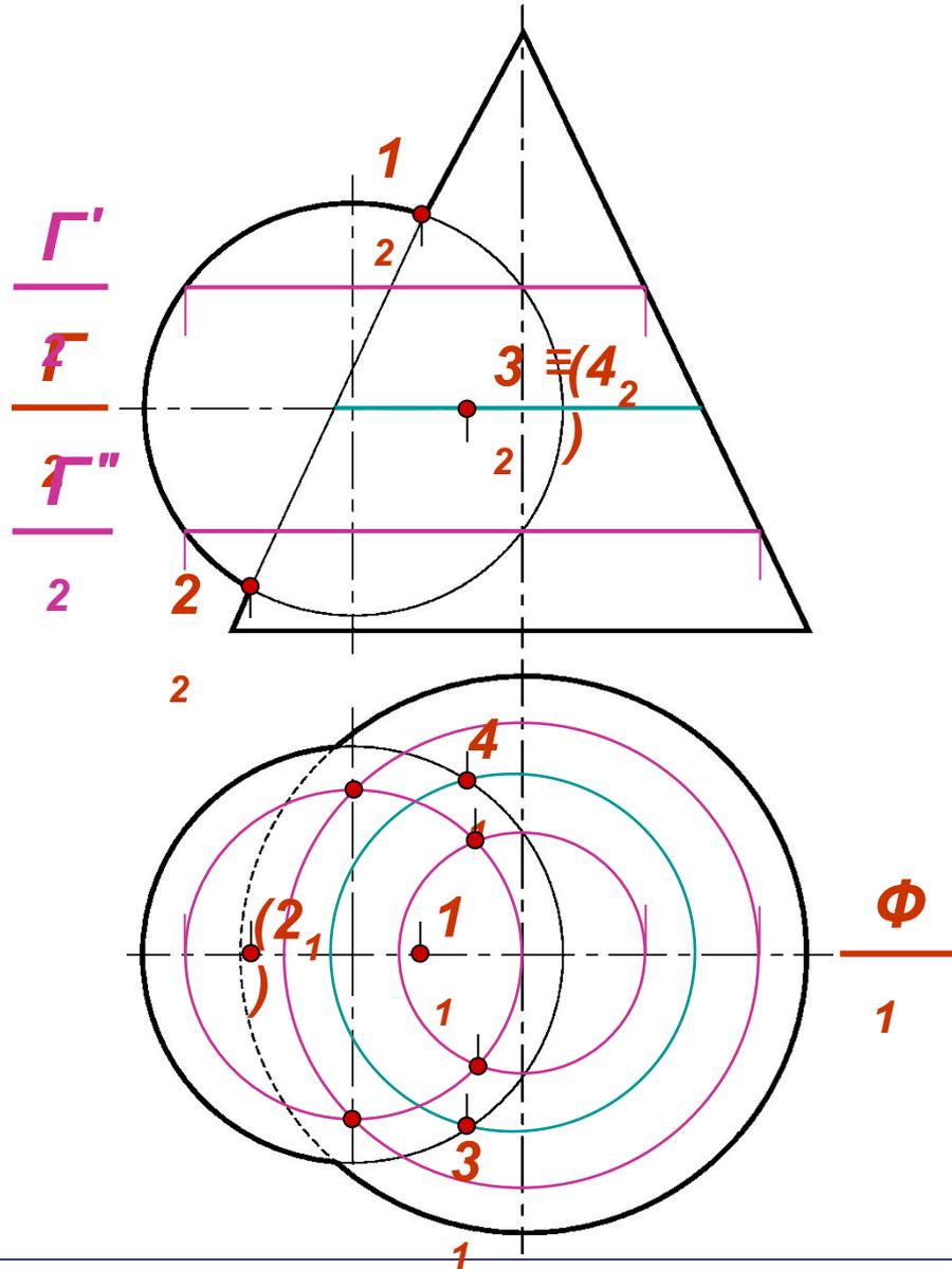
Промежуточные точки, уточняющие форму линии пересечения, находим с помощью вспомогательных горизонтальных плоскостей уровня  $\Gamma'$  и  $\Gamma''$ . На  $\Pi_1$  это будут точки пересечения соответствующих параллелей сферы и конуса. Точки можно оставить без обозначения.
