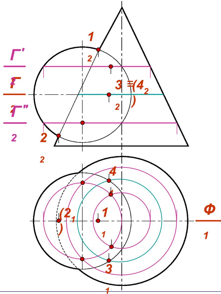
Найденные на горизонтальной плоскости проекций проекции промежуточных точек (они не обозначены на чертеже) переносим на фронтальные следы ( $\Gamma_2'$  и  $\Gamma_2''$ ) плоскостей, с помощью которых промежуточные точки построены.
