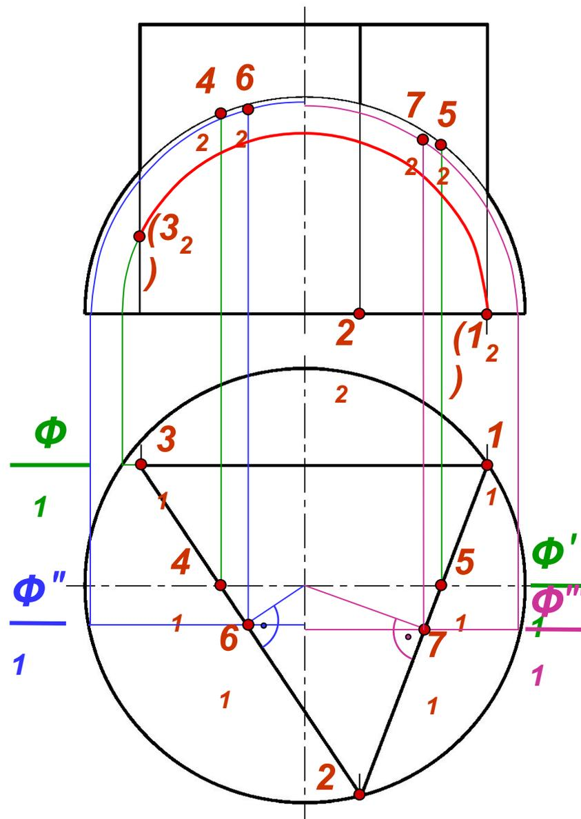
Грани призмы пересекают сферу по <sup>1</sup>окружностям, две из которых проецируются на  $\Pi_2$  в эллипсы. Вершины этих эллипсов (высшие точки линии пересечения) находим на  $\Pi_1$ , обозначив их как 6<sub>1</sub> и 7<sub>1</sub>. Проекции 6<sub>2</sub> и 7<sub>2</sub> находим с помощью плоскостей  $\Phi''$  ( $\Phi_1''$ ) и  $\Phi'''$  ( $\Phi_1'''$ ) соответственно.
