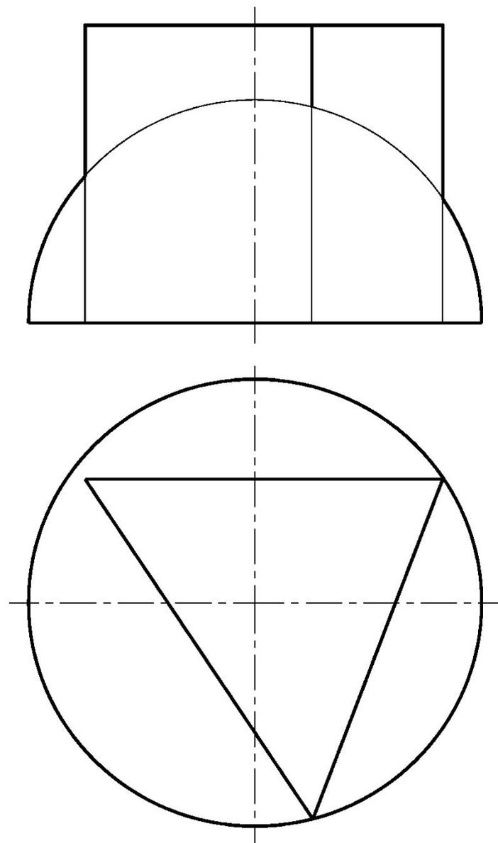
Заданы две пересекающиеся поверхности (полусфера и призма, находящаяся в горизонтально проецирующем положении). Все три грани призмы участвуют в пересечении. Значит, линия пересечения состоит из трех участков, представляющих собой плоские кривые второго порядка.
