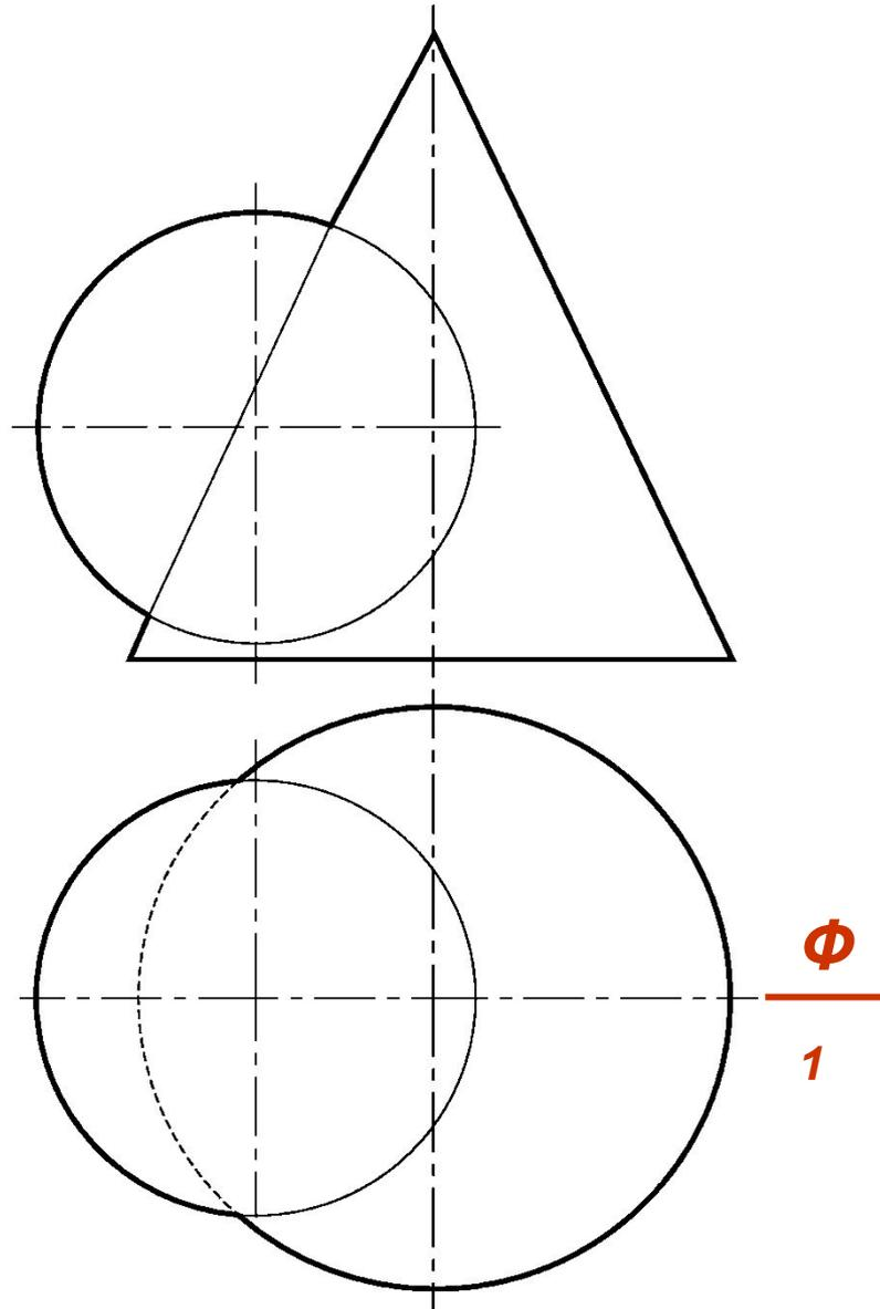
Пересекающиеся поверхности (сфера и конус) имеют общую плоскость симметрии  $\Phi$  ( $\Phi_1$ ), являющейся фронтальной плоскостью уровня. Следовательно, фронтальные очерки поверхностей, лежащие в плоскости  $\Phi$ , пересекаются.
