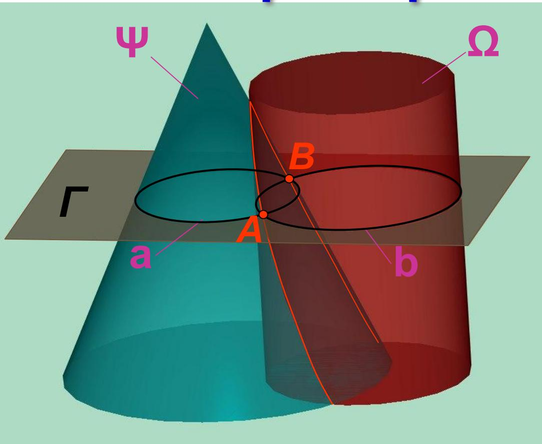
1. Поверхности рассекают вспомогательной секущей плоскостью  $\Gamma$
