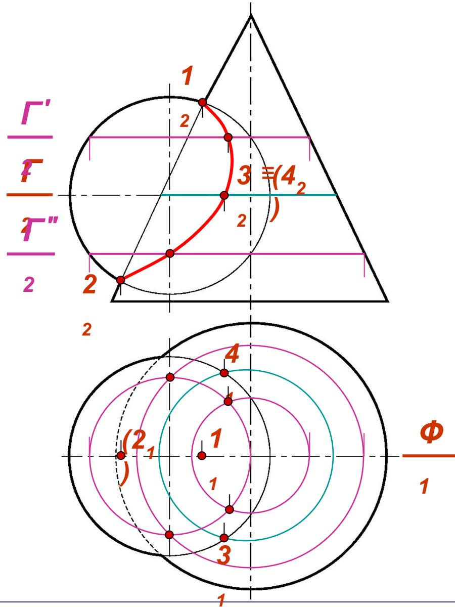
При объединении в линию всех построенных проекций точек на  $\Pi_2$  следует учитывать, что вся линия пересечения разделяется плоскостью  $\Phi$  на две симметричные ветви, которые совпадут на фронтальной плоскости проекций.
