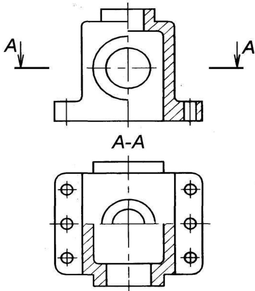
При соединении части (половины) вида с частью (половиной) разреза обозначение наносят по общим правилам обозначения простых разрезов.
