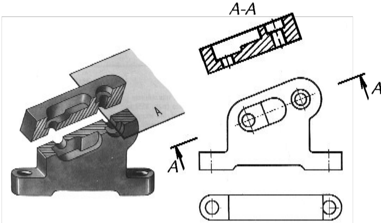
При получении наклонных разрезов секущая плоскость составляет с горизонтальной плоскостью угол, отличный от прямого угла.
