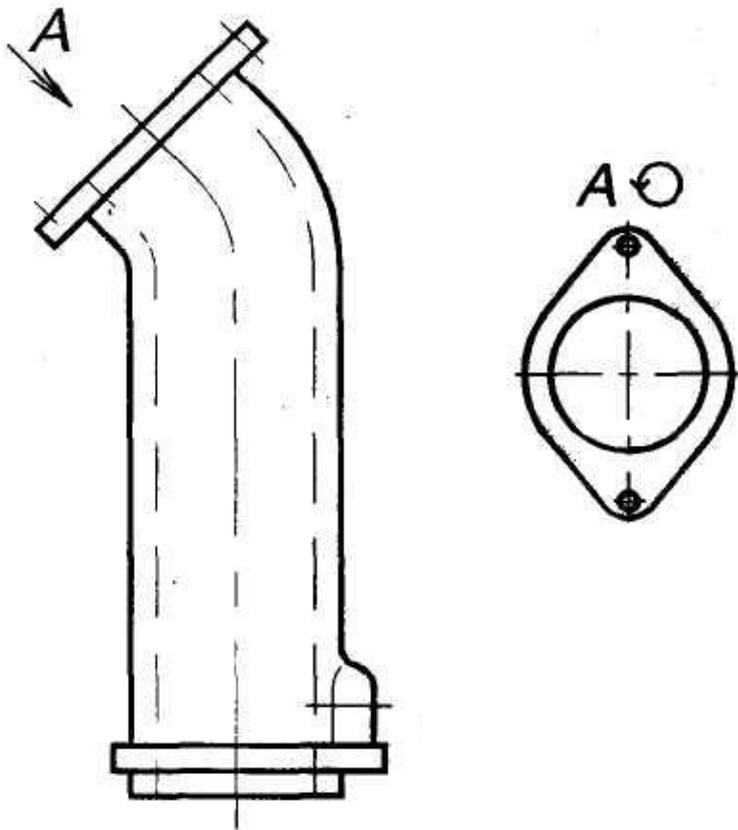
Для удобства чтения чертежа дополнительный вид допускается поворачивать, при этом к надписи должен быть добавлен знак, заменяющий слово «повернуто».
