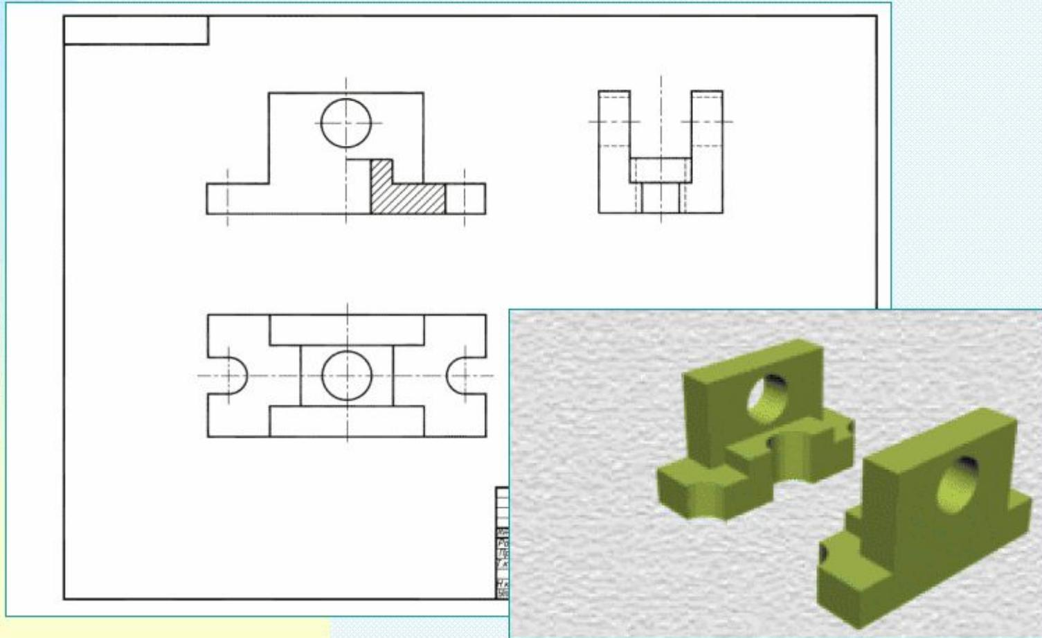
Рациональнее для данной детали дать на фронтальной плоскости проекций изображение половины вида с половиной разреза, т.к. и вид, и разрез являются фигурами симметричными.
