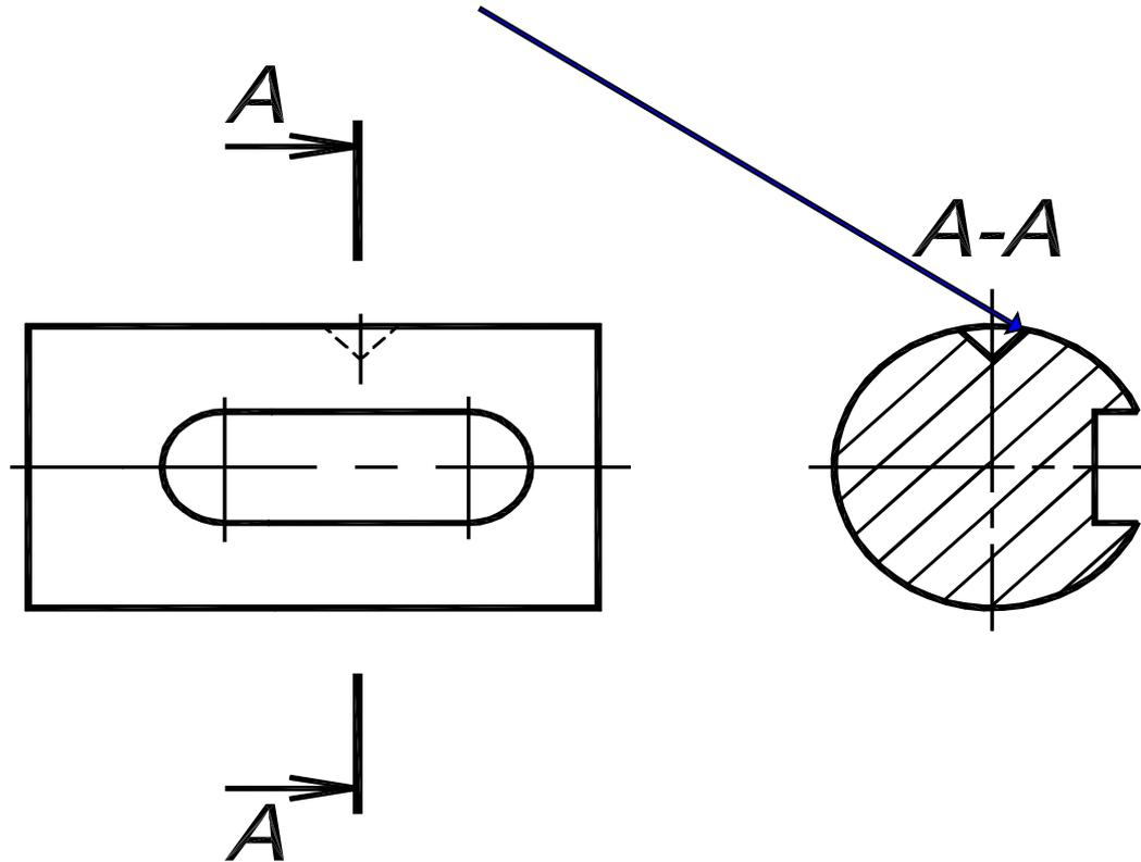
2. Если сечение **распадается на отдельные части**, то его заменяют **разрезом.**
