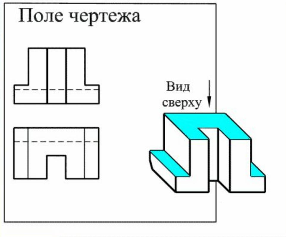
Вид сверху строится на горизонтальной плоскости проекций. Он определяет глубину сквозного паза и третье габаритное измерение. Выполняется в проекционной связи с главным видом.
