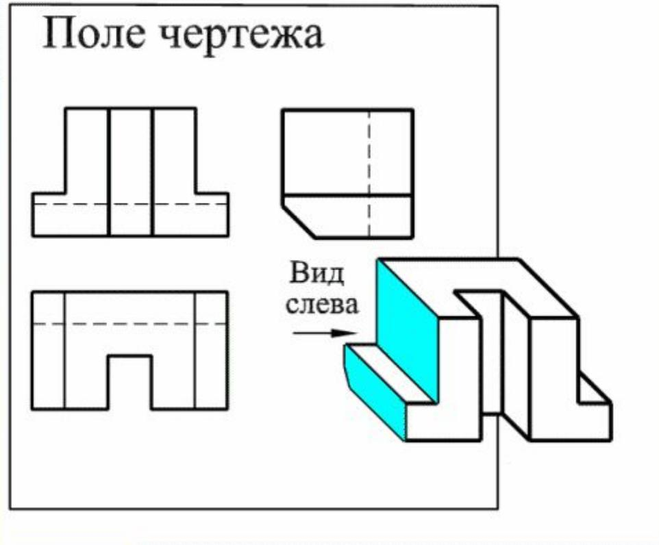
На профильной плоскости проекций следует выполнить вид слева, т.к. на нем виден угол среза детали. Рациональнее выполнить его в проекционной связи с видами спереди и сверху.
