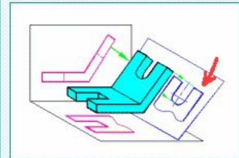
Дополнительная плоскость расположена под углом к горизонтальной плоскости проекций отличным, от 90 градусов.
