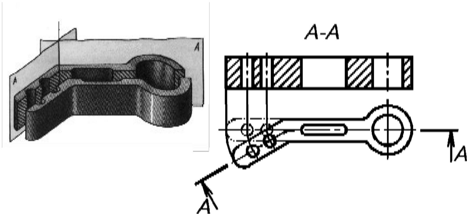
**При ломаных разрезах секущие плоскости условно поворачивают до совмещения в одну плоскость**
