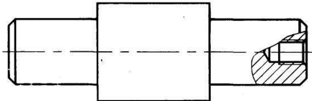
Если местный разрез выполнен на виде, то его **не обозначают**.
