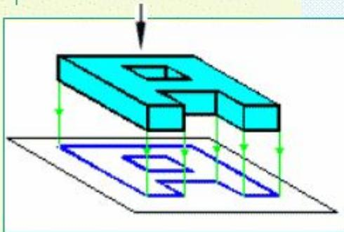
Наблюдатель видит одновременно и предмет, и плоскость, на которой предмет отображается
