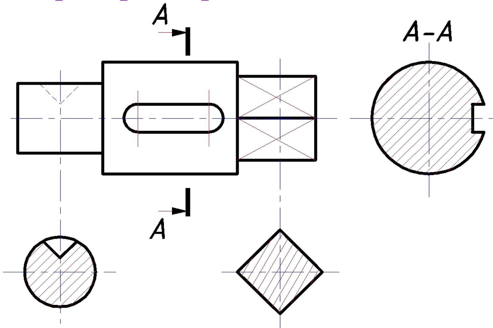
Наносим обозначение сечения с односторонним пазом.
