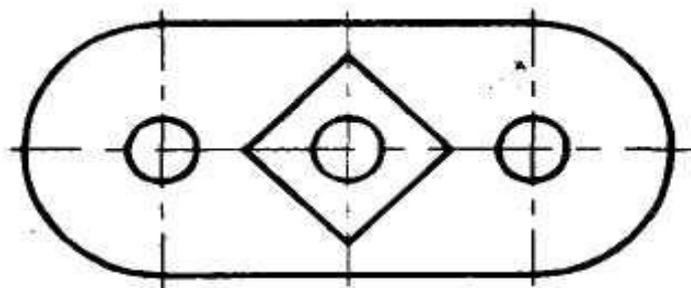
Если соединяется половина вида и половина разреза, каждый из которых является **симметричной** фигурой, то разделяющей линией служит ось симметрии.
