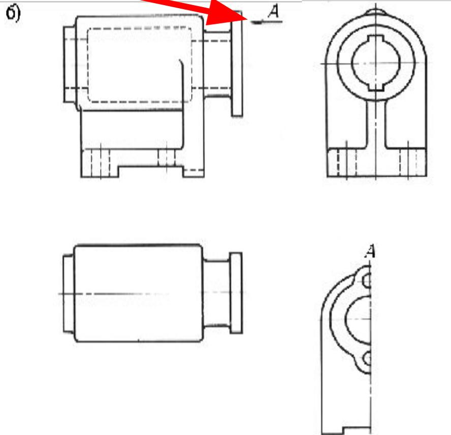
**Дополнительные виды** получают на плоскостях, не параллельных основным плоскостям проекций, например, дополнительный вид А.
