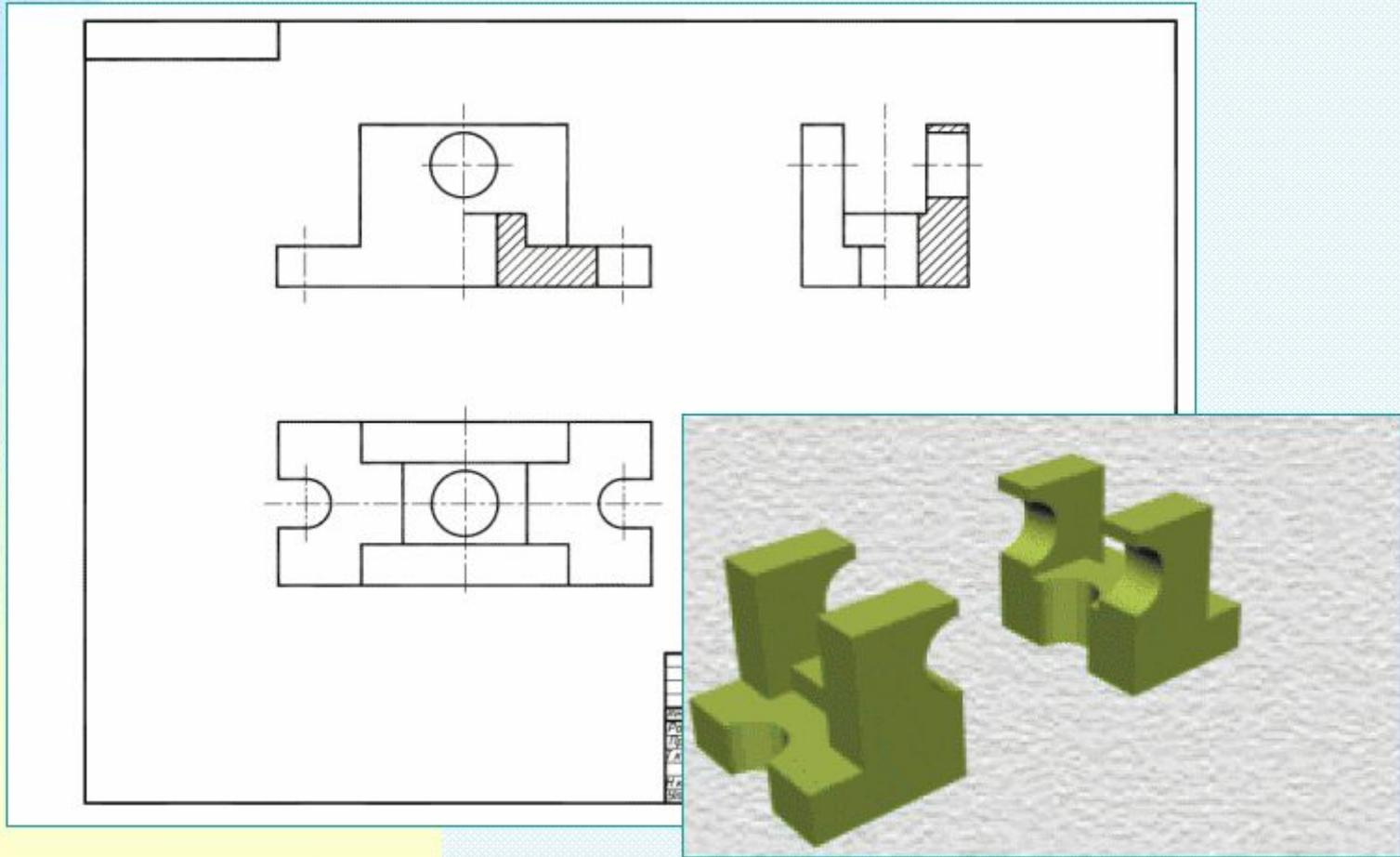
На профильной плоскости проекций также рациональнее выполнить соединение половины вида с половиной разреза.
