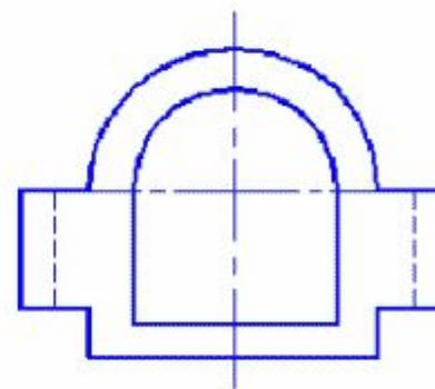
Видимые элементы детали показывают сплошной основной линией. Для уточнения формы детали допускается наносить контуры невидимых элементов с помощью штриховых линий.
