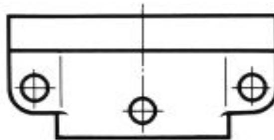
Секущая плоскость - **профильная** плоскость уровня (проходящая через ось симметрии детали).
