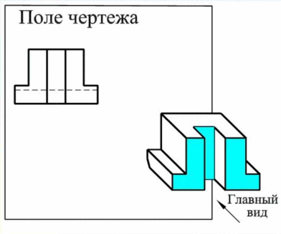
Построение видов на чертеже начинается с выбора главного вида, который строится на фронтальной плоскости проекций.
