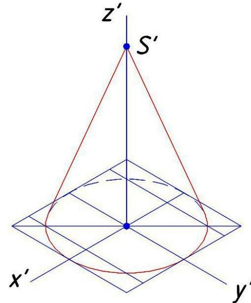
1. Построение проекции окружности проецируется в эллипс.
