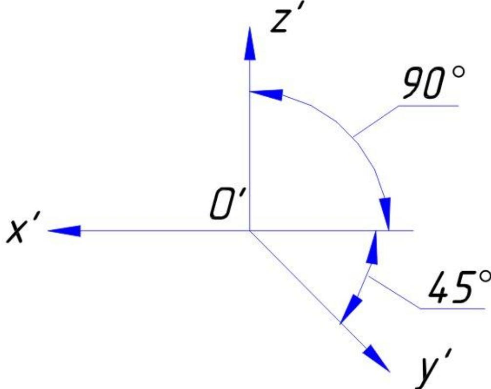
Коэффициенты искажения по осям  $x'$  и  $z'$  равны единице, а по оси  $y'$  принимается равным 0,5. Допускается применять фронтальные диметрические проекции с углом наклона оси  $y'$ , равным 30 и 60°.
