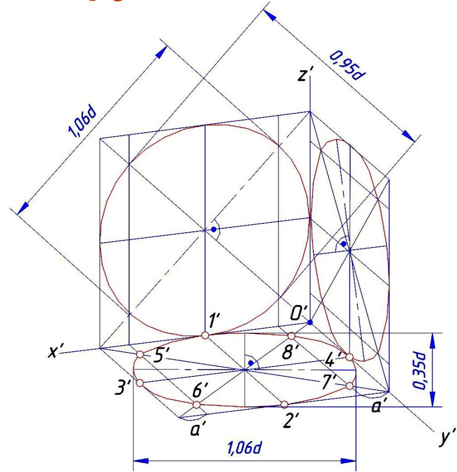
При построении диметрической проекции окружности коэффициент искажения по оси  $y'$  равен 0,5.
