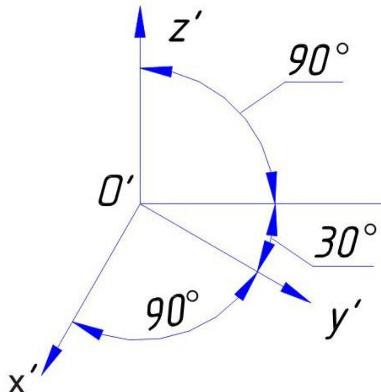
Коэффициенты искажения по всем осям принимаются равными единице. Допускается применять горизонтальные изометрические проекции с углом наклона оси  $y' = 45$  и  $60^\circ$ , сохраняя угол между осями  $x', y' = 90^\circ$ .
