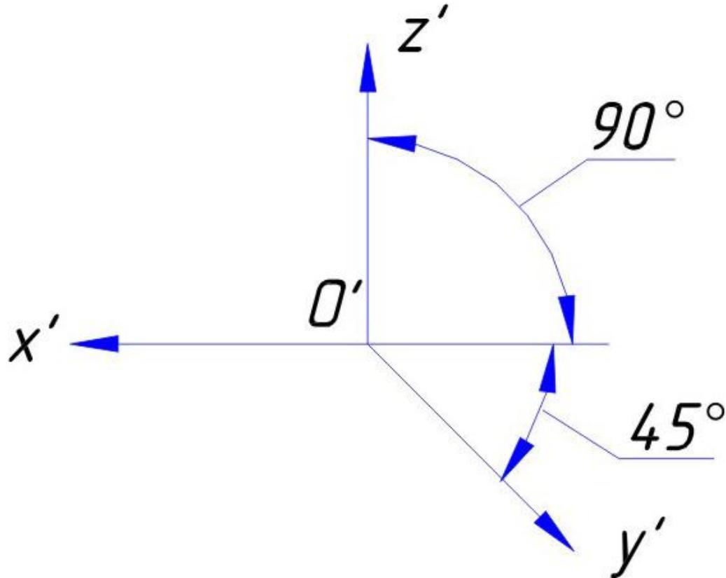
Коэффициенты искажения по всем осям будут равны единице. Допускается применять фронтальные изометрические проекции с углом наклона оси  $y'$ , равным  $30$  и  $60$ °.
