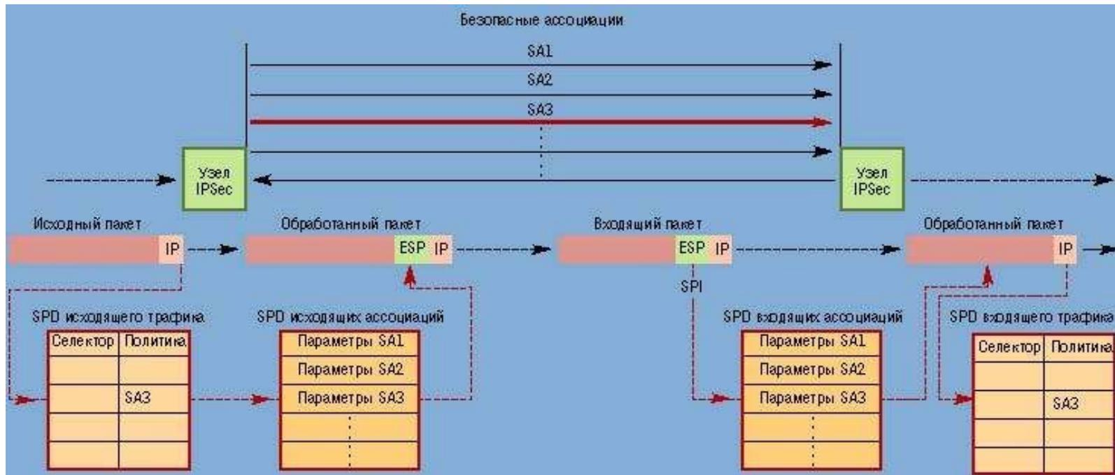
**Установление соответствия между IP-пакетами и правилами их обработки.**
