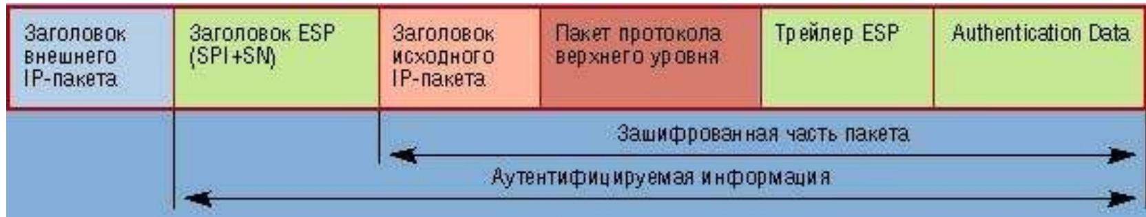
**Структура результирующего пакета протокола ESP в туннельном режиме.**
