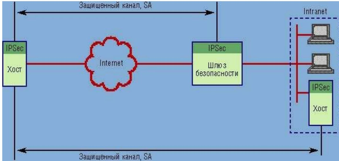
**Схема «хост-шлюз», дополненная для надежности каналом «хост-хост».**
