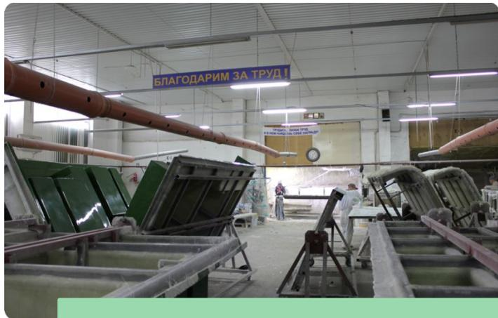
Процесс производства стеклопластиковых изделий начинается с подачи матрицы, которая устанавливается на платформу. Потом на нее наносится гелькаут. После сушки наносится армирующий слой. Для этого используется смола, нанопорошок и стекловолокно.
