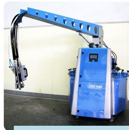
Смесительно-дозировочная установка высокого давления **OSV H40** предназначена для заливки широкого спектра двухкомпонентных пенополиуретанов при производстве формованных деталей стендовым способом.
