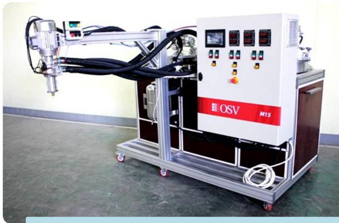
Установка **OSV M15** предназначена для автоматического смешивания, дозирования и заливки ряда двух- и трехкомпонентных полиуретановых эластомеров горячего на основе MDI (квазисистем). Благодаря значительному диапазону регулировок рабочих параметров оборудования, она способна перерабатывать широкий диапазон различных полиуретановых эластомеров.
