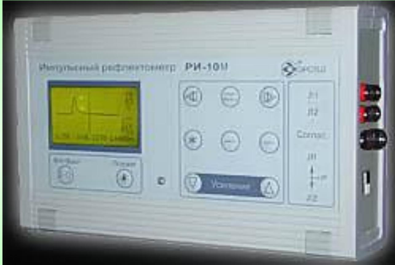
Импульсный рефлектометр РИ-10М
