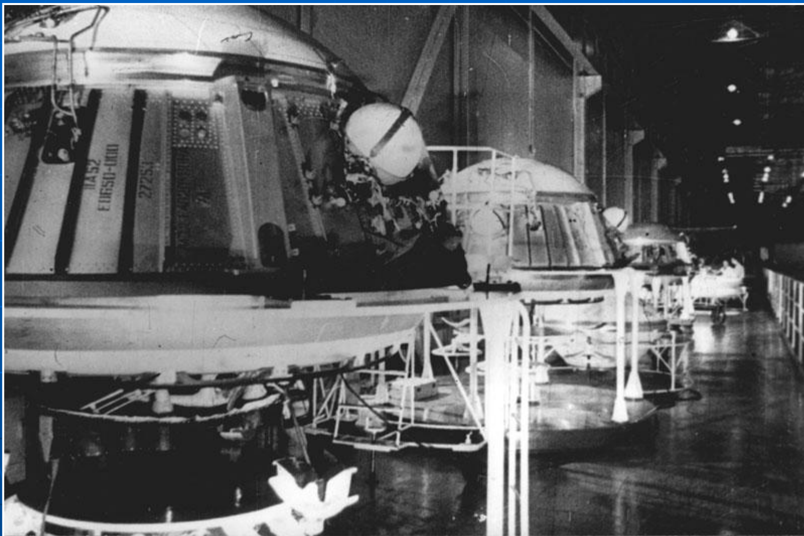
Разработанные в КБ «Южное» ракетные блоки Е лунного корабля в цехе завода «Южмаш» Ракетні модулі Е місячного корабля, які розроблені в КБ «Південне», в цеху заводу „Південмаш”
