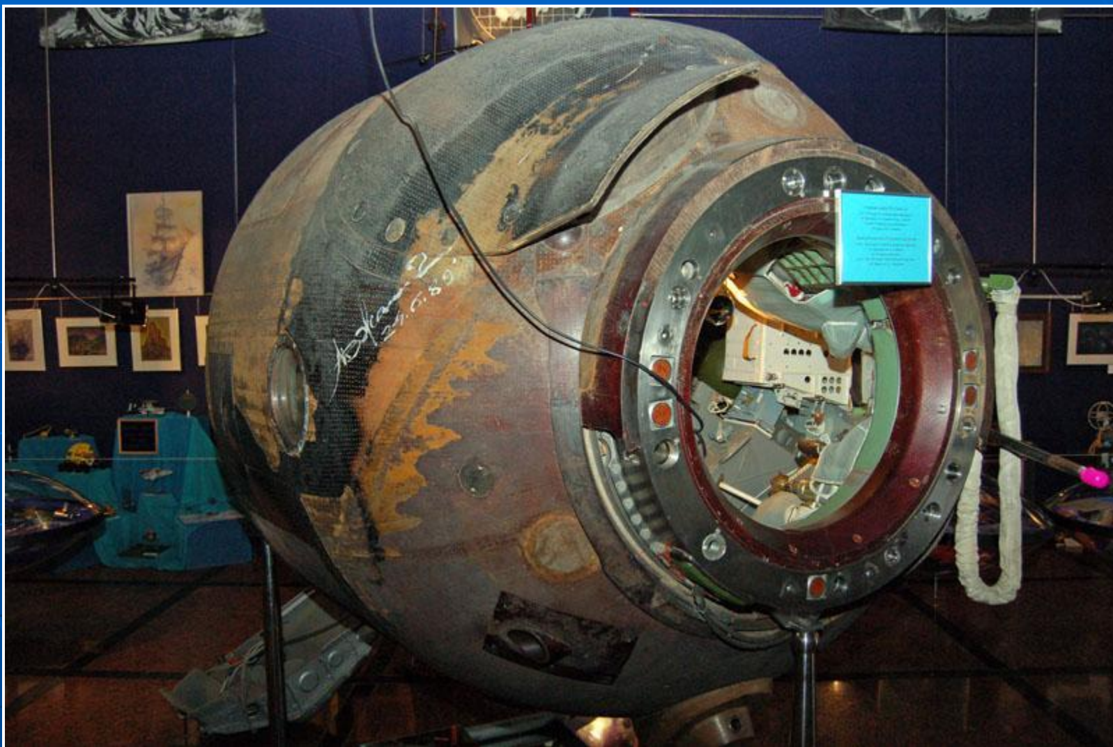
Спускаемая капсула космического корабля «Союз»
