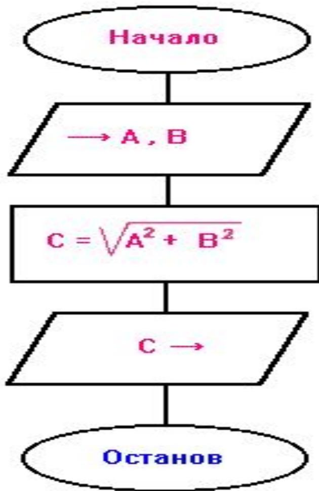
Блок-схема линейного алгоритма вычисления выражения
