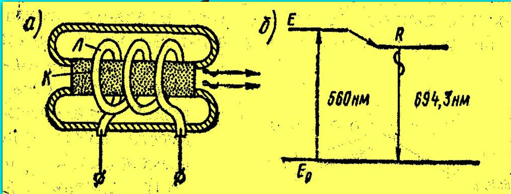
Кристалл  $K$  (рис.4,а) имеет удлиненную цилиндрическую форму со строго параллельными отшлифованными и посеребренными торцами. Таким образом, он представляет **зеркальный резонатор**; **передний торец его полупрозрачен.**
