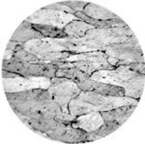
обжатие 30%. Зерна сжаты в направлении обжатия.
