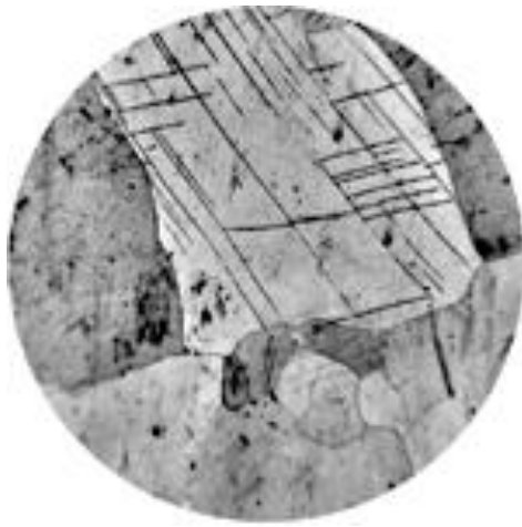
обжатие 5%. составляющие: феррит Субструктура: Однородная с линиями сдвига
